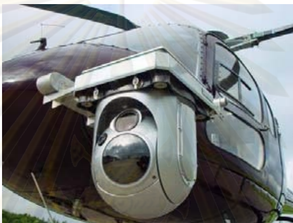
รูปที่ 2.3 กิมบอลส์สำหรับงานถ่ายภาพวีดิทัศน์ทางอากาศ
