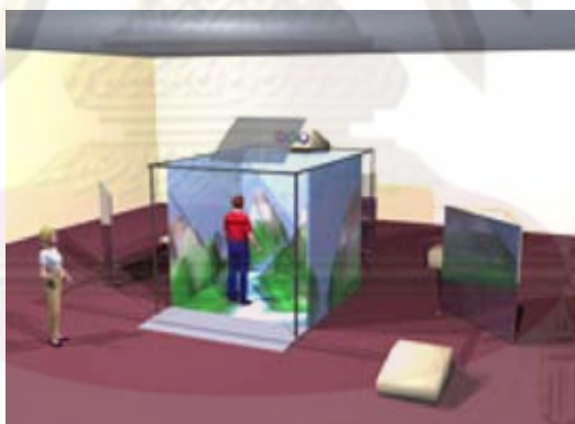
รูปที่ ข.1 ภาพจำลองเครื่องมือ CAVE แบบ 4 ด้าน
