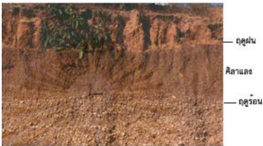
รูปที่ 2.8 ชั้นศิลาแลงที่เกิดขึ้นจากการเปลี่ยนระดับของน้ำบาดาลซึ่งชะละลายสารแขวนลอยเหล็กออกไซด์ ทั้งจากดินพื้นผิว และจากตะกอนกรวดด้านล่าง (5)
