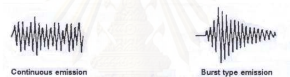
รูปที่ 2.27 : สัญญาณอะคูสติกแบบต่อเนื่องและแบบที่เกิดเป็นช่วงๆ [7]
