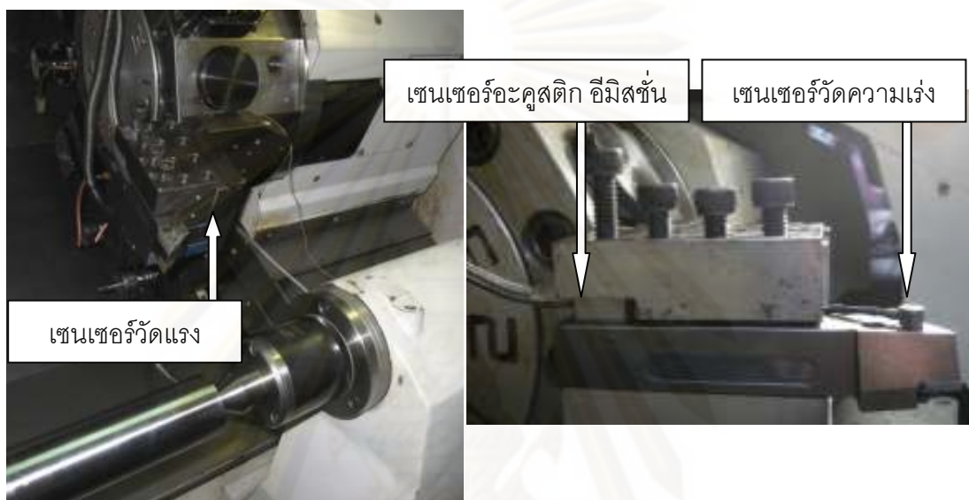
รูปที่ 3.9 : ภาพแสดงการติดตั้งเซนเซอร์วัดแรง,เซนเซอร์วัดความเร็วและเซนเซอร์อะคูสติก อิมิตชัน
