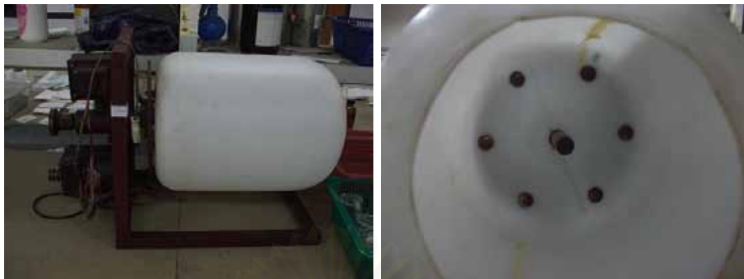
รูป 2 ก. : ถังผสม (ได้รับความอนุเคราะห์จาก รศ. ดร. เจดศักดิ์ ไชยคุณา)
