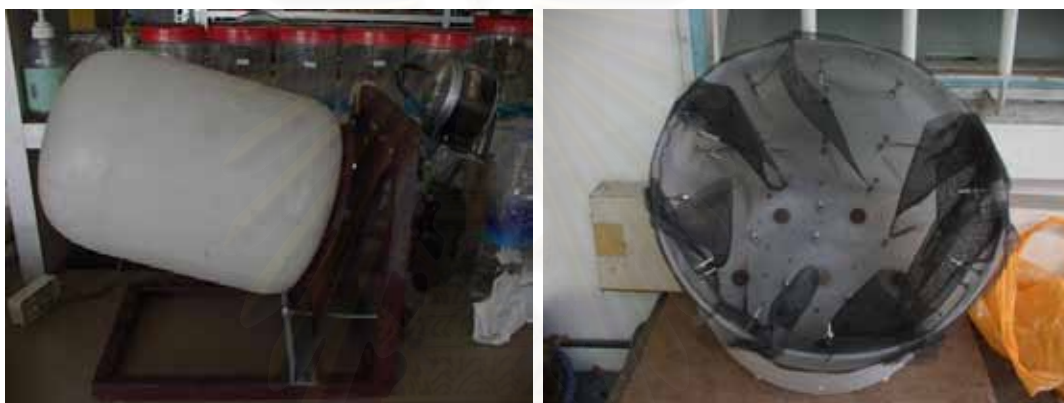
รูป 2 ข. : ถังผสมที่ทำการซ่อมแซมเพื่อใช้ในการงานวิจัย
