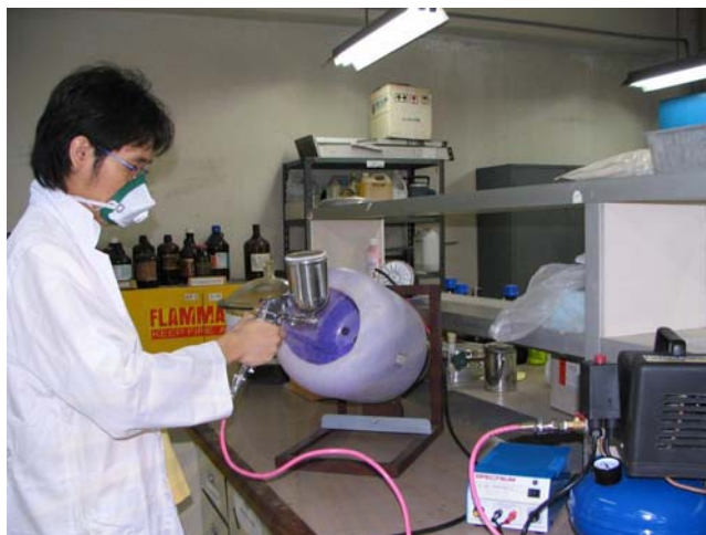
รูปที่ 3.2 : กระบวนการพ่นเคลือบด้วยสารละลายพอลิเมอร์ (ถึงผสมได้รับความอนุเคราะห์จาก รศ. ดร. เจดศักดิ์ ไชยคุณา)
