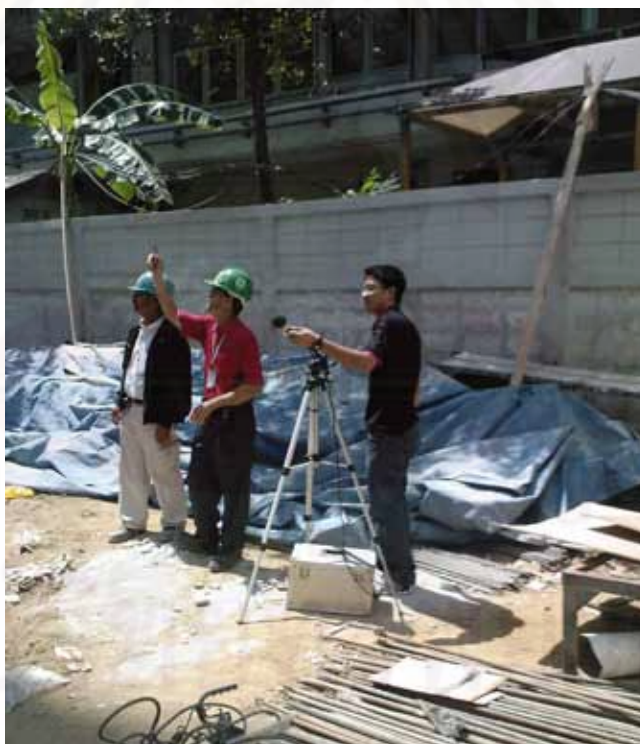
รูปที่ 4.6.3 การตรวจวัดระดับเสียงในพื้นที่ก่อสร้าง
