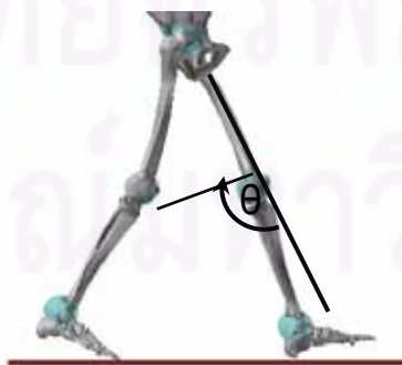
รูปที่ 6.7 ทิศทางการวัดมุมของข้อเข่าโดยเริ่มจากขาเหยียดตรง
