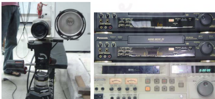
รูปที่ 3.2 ชุดเครื่องมือที่ใช้ในการทำ Motion Capture มีกล้อง (ซ้าย) และเครื่องวิดีโอ (ขวา)
