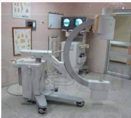
รูปที่ 3.6 Mobile C-Arm Unit สามารถปรับหมุนและเลื่อนแนวการฉายรังสีได้
