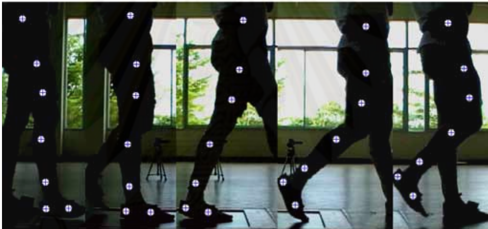
รูปที่ 5.7 ตำแหน่งของมาร์กเกอร์จากการประมวลผลภาพ
