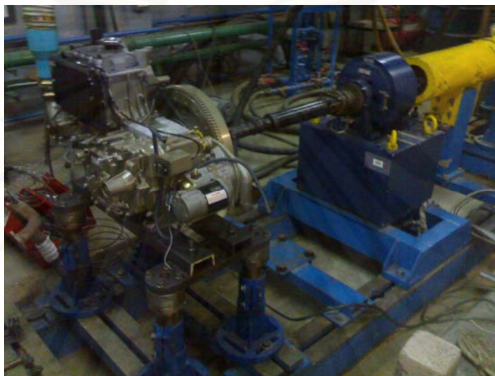
รูปที่ 6-25 เครื่องยนต์บนแท่นทดสอบต่อกับไดนาโมมิเตอร์
