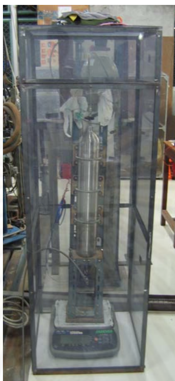
รูปที่ 6-3 อุปกรณ์การวัดอัตราสิ้นเปลืองน้ำมันเชื้อเพลิง
