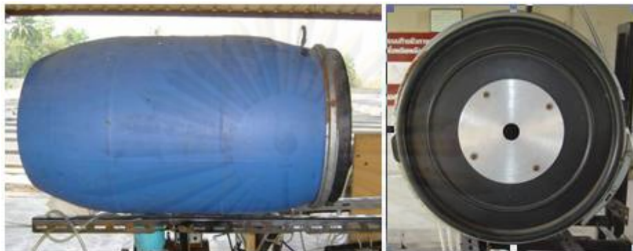
รูปที่ 6-8 ถังพักอากาศและการติดตั้ง Orifice Plate
