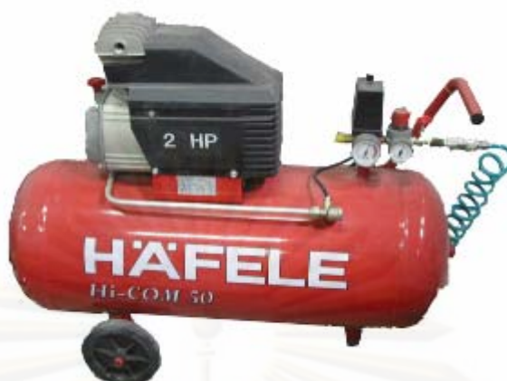
รูปที่ 6-33 เครื่องอัดอากาศ
