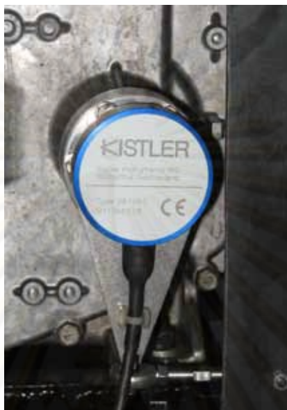
รูปที่ 6-22 Crank Angle Encoder ยี่ห้อ Kistler รุ่น 2613B
