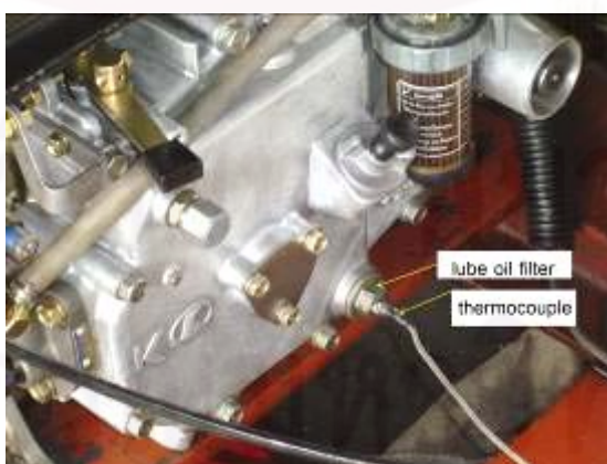
รูปที่ 6-5 การติดตั้งตำแหน่งของเทอร์โมคัปเปิลที่ตัวกรองน้ำมันหล่อลื่น
