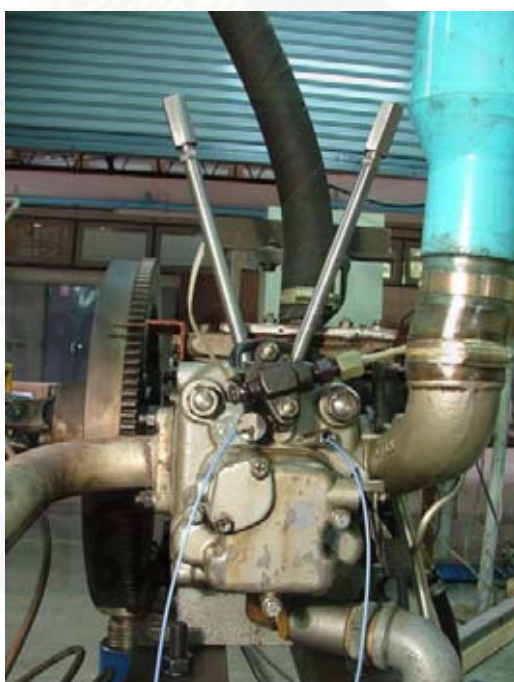
รูปที่ ๑-5 ฝาสูบของเครื่องยนต์วิจัยขณะติดตั้งอยู่บนแท่นทดสอบ [56]
