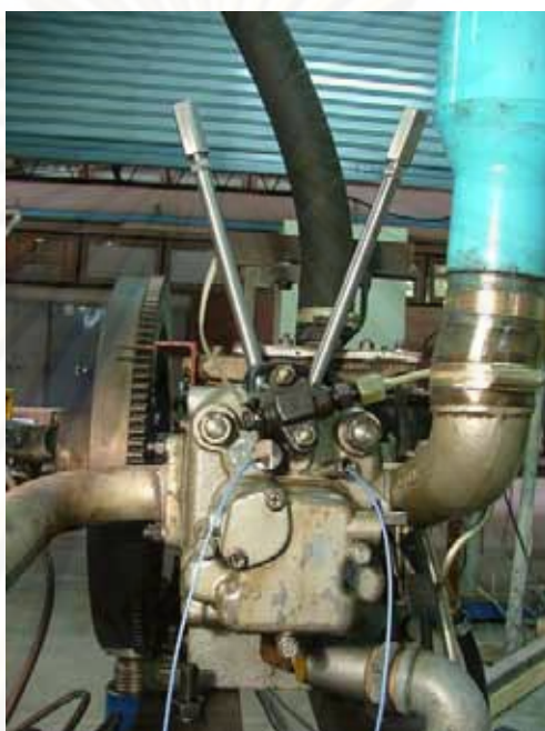
รูปที่ 6-32 ตำแหน่งการติดตั้ง Sleeve สำหรับถ่ายภาพการเผาไหม้
