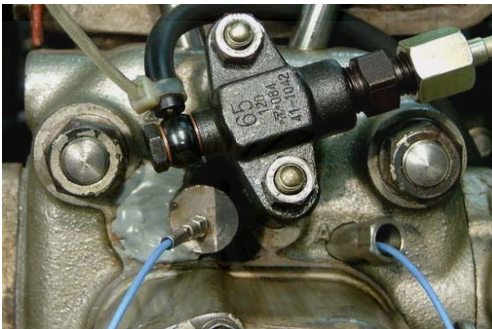
รูปที่ ๑-4 ฝาสูบที่ได้รับการดัดแปลงเพื่อติดตั้ง pressure transducer ที่ pre-chamber และ main chamber เรียบร้อยแล้ว [56]
