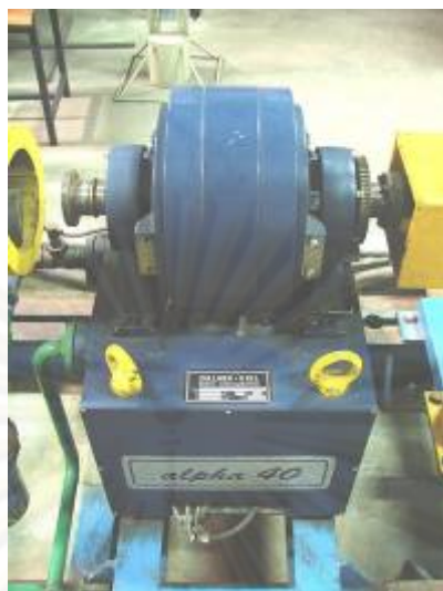
รูปที่ 6-26 ไดนาโมมิเตอร์ที่ใช้ในการทดสอบ
