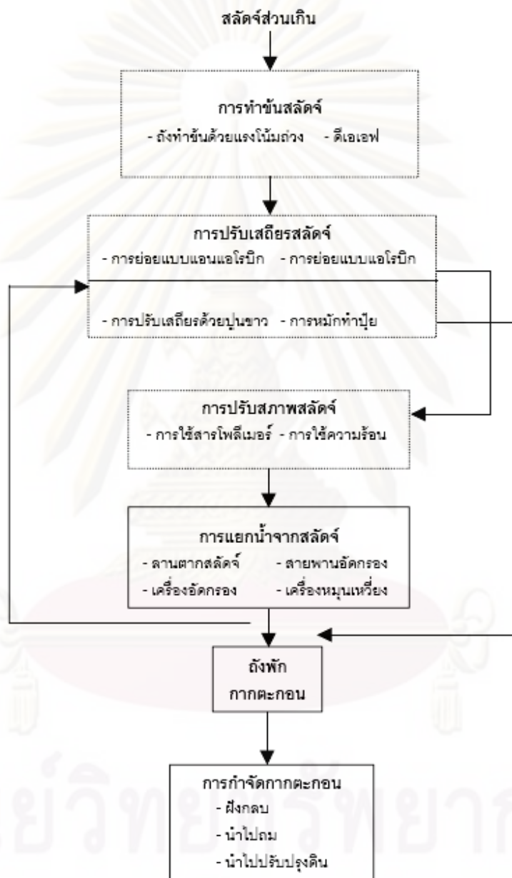
ภาพที่ 2.4 กระบวนการและขั้นตอนการบำบัดและกำจัดสลัดจ์
