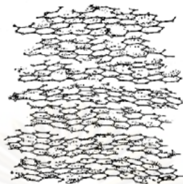
ภาพที่ 2.10 ลักษณะการแบ่งชั้นของโครงสร้างถ่านกัมมันต์ (Faust และ Aly, 1987)
