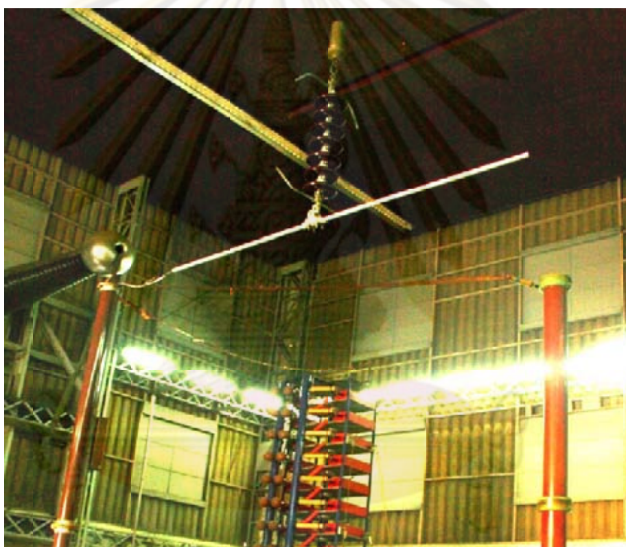
รูปที่ 4.5 การทดสอบหาแรงดันวาทไฟวิกฤต U_{50\%} ต่อการเปลี่ยนแปลงหน้าคลื่นอิมพัลส์ของอุปกรณ์อาร์คซึ่งฮอว์นแบบแท่งกลม-แท่งกลม
