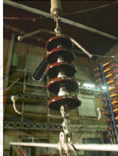
(ข) อาร์คซึ่งฮอร์นแบบทรงกลม-ทรงกลม ติดตั้งกับลูกถ้วยแขวนจำนวน 5 ลูก
