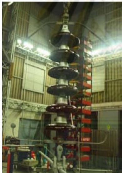
(ค) อาร์คซึ่งฮอร์นแบบทรงกลม-ทรงกลม ติดตั้งกับลูกถ้วยแขวนจำนวน 6 ลูก
