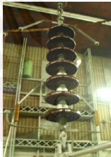
(ง) อาร์คซึ่งฮอร์นแบบทรงกลม-ทรงกลม ติดตั้งกับลูกถ้วยแขวนจำนวน 7 ลูก
