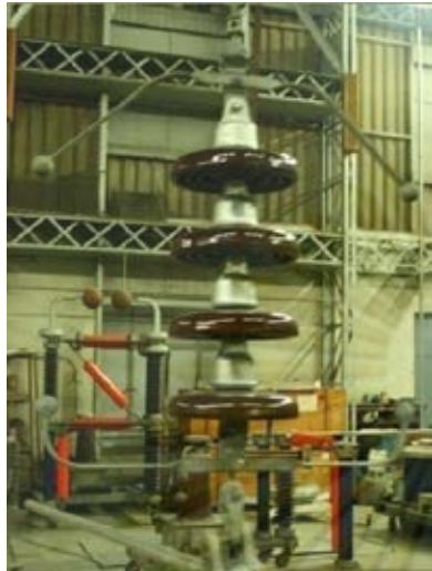
(ก) อาร์คซึ่งฮอร์นแบบทรงกลม-ทรงกลม ติดตั้งกับลูกถ้วยแขวนจำนวน 4 ลูก
