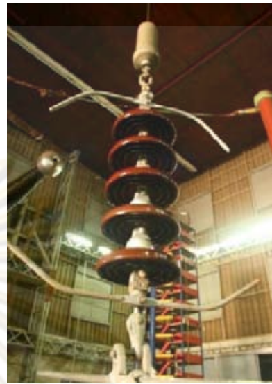
(ข) อาร์คซึ่งฮอรั่นแบบแบ่งกลม-แบ่งกลม ติดตั้งกับลูกถ้วยแขวนจำนวน 5 ลูก
