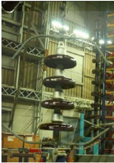
(ก) อาร์คซึ่งฮอรั่นแบบแบ่งกลม-แบ่งกลม ติดตั้งกับลูกถ้วยแขวนจำนวน 4 ลูก
