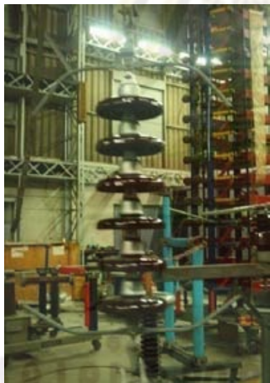
(ค) อาร์คซึ่งฮอรั่นแบบแบ่งกลม-แบ่งกลม ติดตั้งกับลูกถ้วยแขวนจำนวน 6 ลูก
