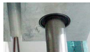
รูปที่ 6.10 ตลับลูกปืนที่แท่นกดและร่องสำหรับเสี้ยนไขขอบเขตแบบง่าย
