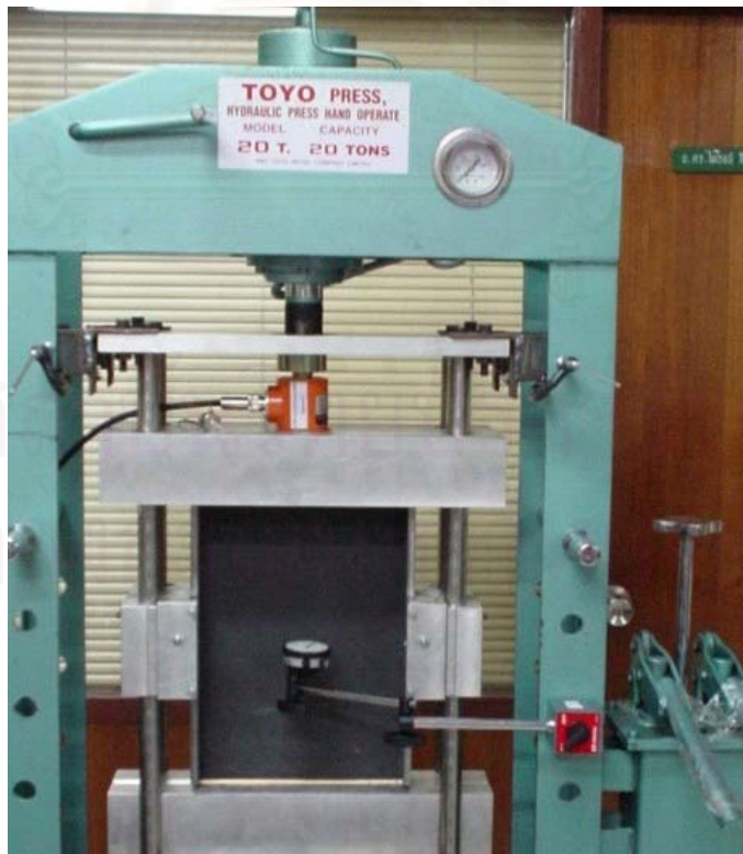
รูปที่ 6.1 ชุดทดลองที่ใช้ในการหาค่าภาระการโก่งงอ
