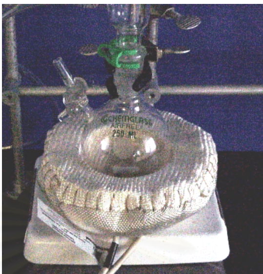
รูป 3.1 อุปกรณ์ชุดรีฟลักซ์
