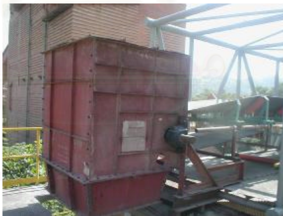
แผนภาพที่ 4.18 แสดงชิ้นส่วนที่เคลือบสีรองพื้นแล้ว
