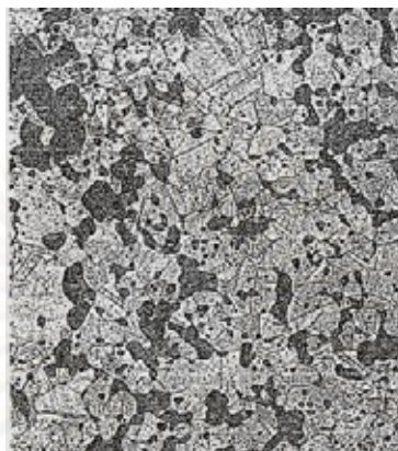
ภาพที่ 2.7 โครงสร้างจุลภาคของสารละลายของแข็งแอลฟาบรอนซ์ (150 X) [2]
