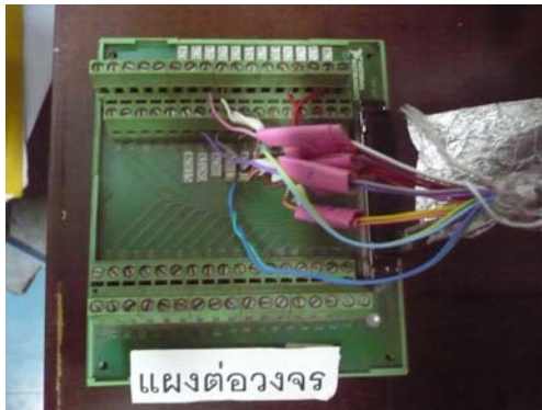
ก) แผงวงจรต่อสัญญาณ
