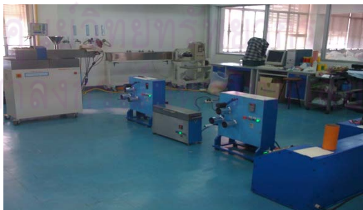
รูปที่ 3.6 เครื่องปั่นเส้นใยแบบหลอมเหลวชนิดสกรูเดี่ยว
