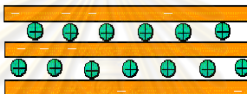
รูปที่ 2.5 แรงดึงดูดไฟฟ้าสถิตย์ที่ยึดแผ่นโครงสร้างของเคลย์ [15]
