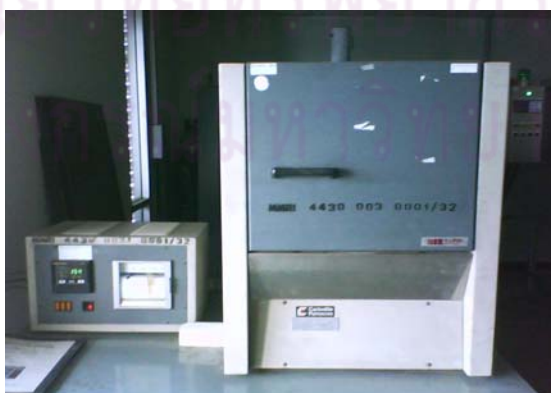
รูปที่ 3.17 เตาเผาไฟฟ้า 1600 องศาเซลเซียส
