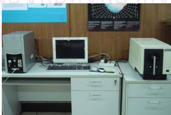
รูปที่ 3.20 เครื่องวัดสี (Reflectance spectrophotometer)
