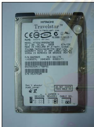
รูปที่ 3.8 ฮาร์ดดิสก์ HITACHI ขนาด 60 GB
