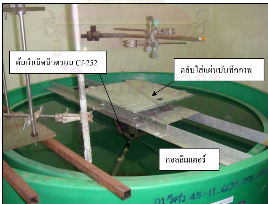
รูปที่ 3.1 ต้นกำเนิดนิวตรอนแคลิฟอร์เนียม-252 ที่อยู่ในถังโพลีเอทิลีนบรรจุน้ำ พร้อมคอลลิเมเตอร์และตลับใส่ฟิล์ม
