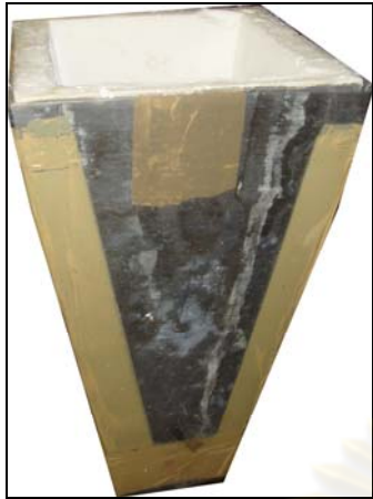
รูปที่ 3.2 นิวตรอนคอลลิเมเตอร์หุ้มด้วยตะกั่วหนา 3 มิลลิเมตร
