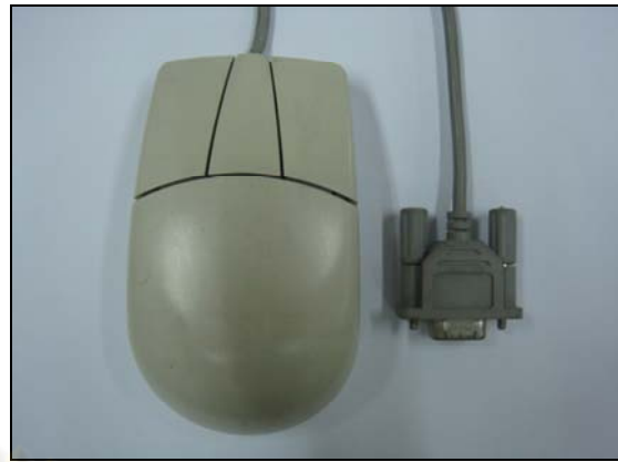
รูปที่ 3.11 เมาส์แบบลูกกลิ้งและหัวต่อแบบ DB-9
