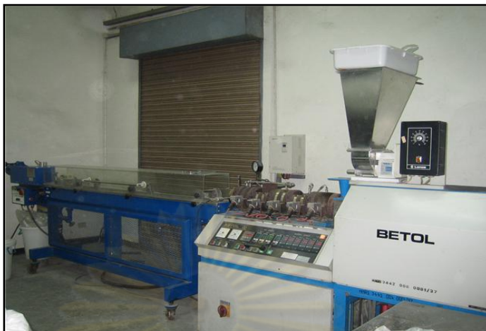
รูปที่ 3.3 เครื่องอัดรีดแบบสกรูคู่ของบริษัท BETOL
