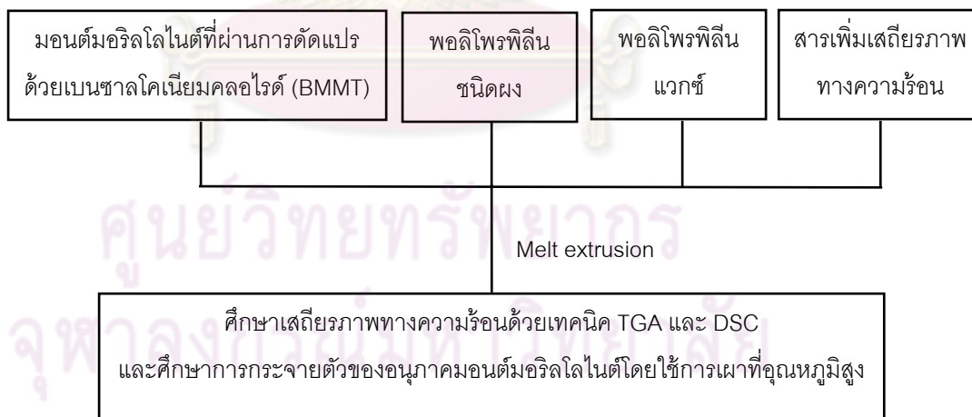
รูปที่ 3.4 ขั้นตอนการเตรียมนาโนคอมพอสิตของพอลิโพรพิลีน/BMMT นาโนคอมพอสิต
