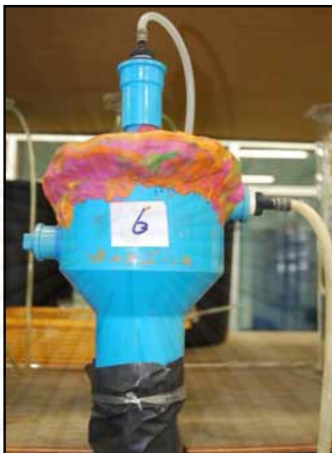
ภาพที่ 3.8 อุปกรณ์แยกสามสถานะ (Gas-Solid Separator ; GSS)
