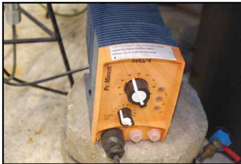
ภาพที่ 3.4 เครื่องสูบน้ำเสียแบบ Diaphragm Pump
