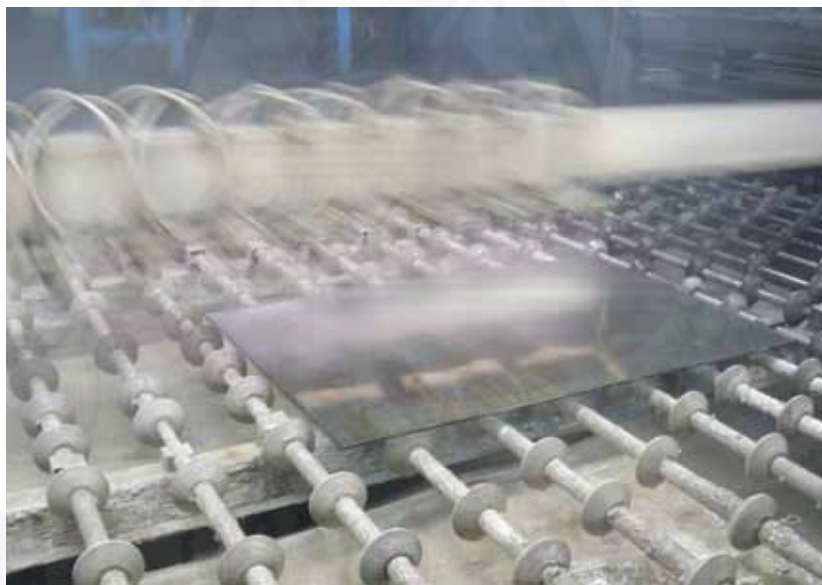
รูปที่ 4.5 กระจกทดลองระหว่างการทดสอบเคลือบเงิน
