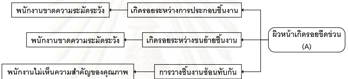
รูปที่ 4.4 แสดงการวิเคราะห์หาสาเหตุของผิวหนังเกิดรอยขีดข่วนจากขั้นตอนการประกอบโดยใช้ แผนภูมิต้นไม้ (Tree Diagram)
