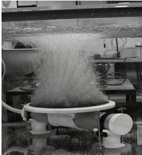
รูปที่ 2.26 การใช้เทคนิค CSP สำหรับการวัดขนาดฟองอากาศที่มีความหนาแน่นสูง
