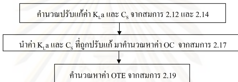
รูปที่ 3.16 การหาค่า OC และ OTE
