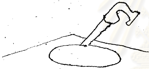
compass saw หรือเลื่อยฉลุ ใช้สำหรับตัดหรือฉลุไม้ที่เป็นรูปโค้งหรือวงกลม ซึ่งมีรัศมีโค้งมาก
