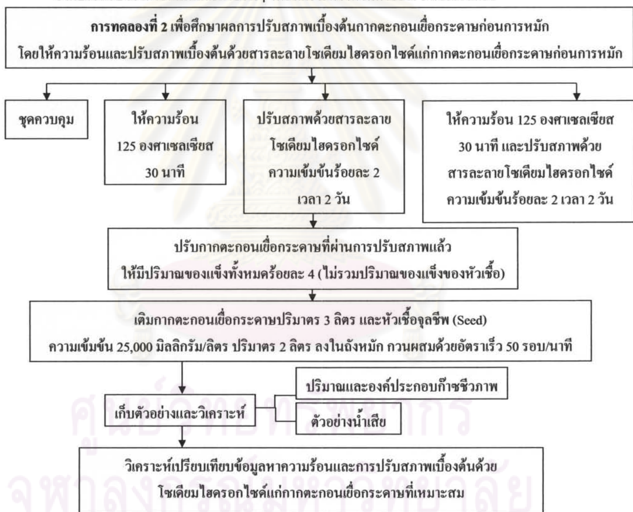
ภาพที่ 3.4 ผังการทดลองอัตราการผลิตก๊าซชีวภาพจากกากตะกอนเชื้อกระดาษที่ปรับสภาพเบื้องต้นด้วยการให้ความร้อนและสารละลายโซเดียมไฮดรอกไซด์
