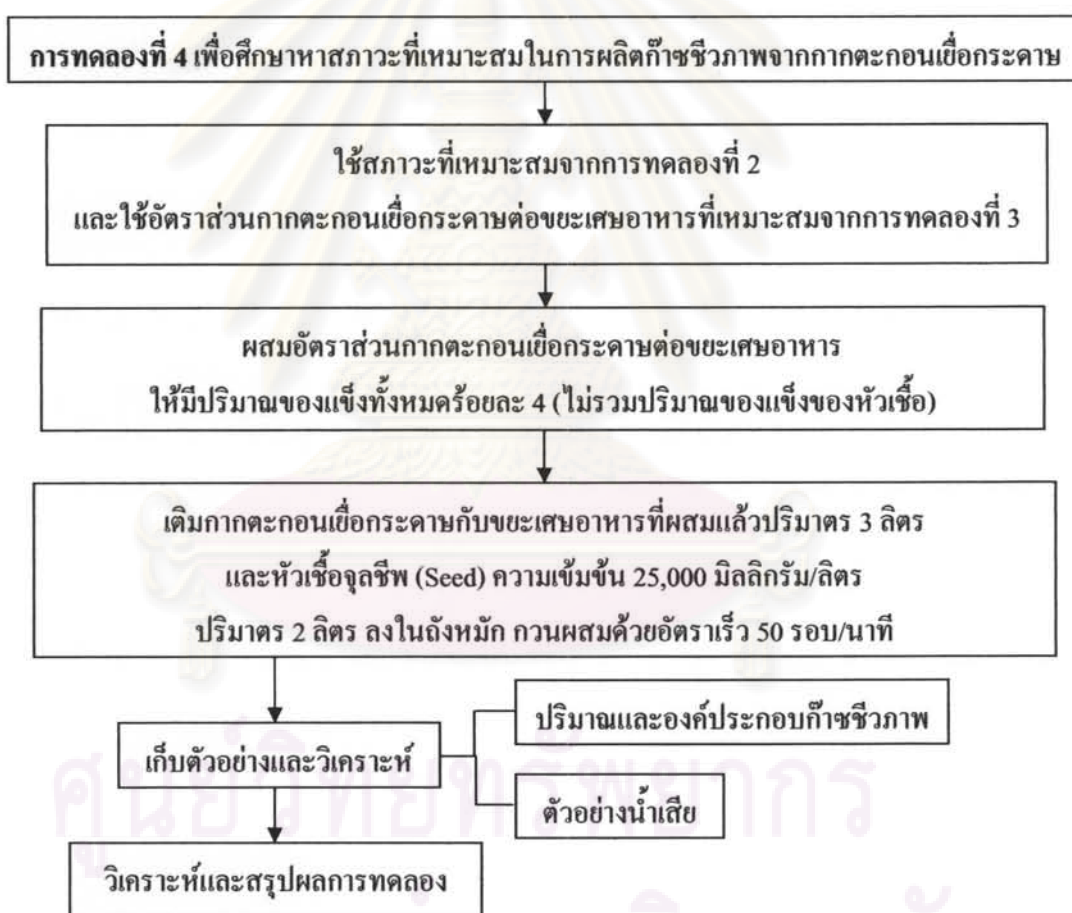
ภาพที่ 3.6 ผังการทดลองอัตราการผลิตก๊าซชีวภาพจากกากตะกอนเยื่อกระดาษและขยะเศษอาหารที่สภาวะที่เหมาะสม
