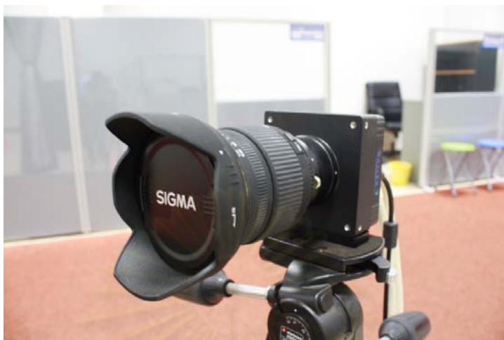
ภาพภาคผนวกที่ 2 แสดงกล้องจับภาพการเคลื่อนไหวความเร็วสูง (ข.)
