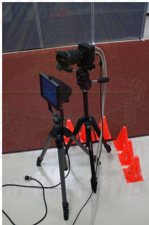
ภาพภาคผนวกที่ 1 แสดงกล้องจับภาพการเคลื่อนไหวความเร็วสูง (ก.)
