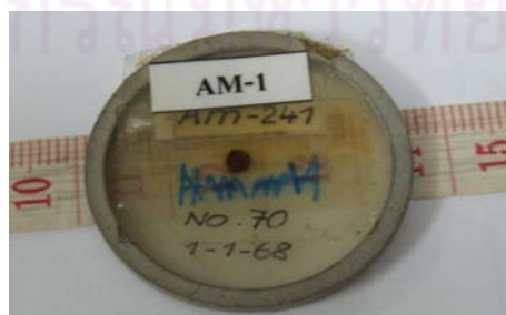
รูปที่ 3.5 ต้นกำเนิดรังสีแกมมา Am-241 ความแรงรังสี 9.72 มิลลิวูรี
