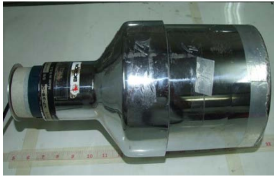
รูปที่ 3.2 หัววัดรังสีแกมมาโซเดียมไอโอไดต์ (NaI(Tl) ขนาด 5 นิ้ว x 5 นิ้ว
