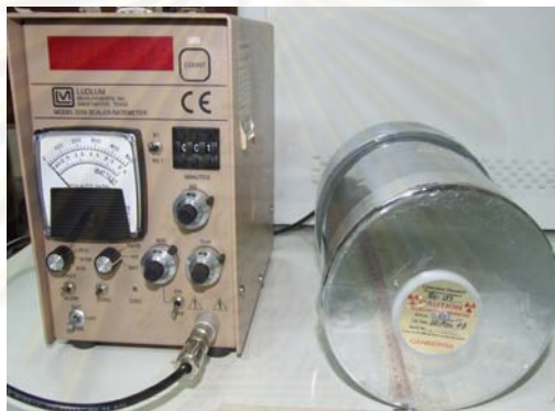
รูปที่ 3.13 การหาค่า LLD สำหรับวัดต้นกำเนิดรังสีมาตรฐาน Cs-137
