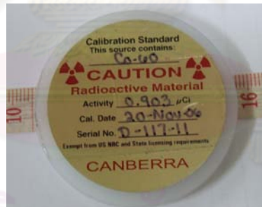
รูปที่ 3.4 ต้นกำเนิดรังสีแกมมา Co-60 ความแรงรังสี 0.60 มิลลิวูรี
