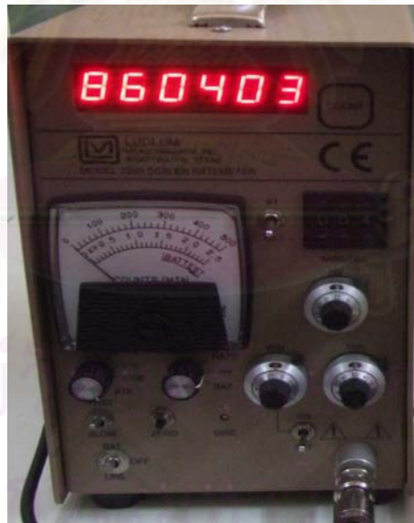
รูปที่ 3.1 เครื่องวิเคราะห์แบบช่องเดียว (Sing Channel Analyzer, SCA) LUDLUM Model 2200
