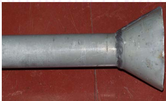
รูปที่ 3.9 ตัวอย่างที่ 3 โลหะปนเปื้อนวัสดุกัมมันตรังสี
