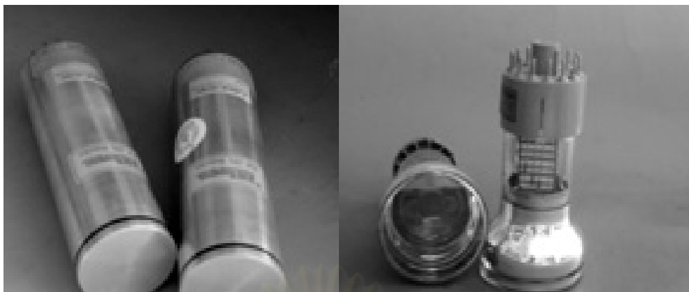
รูปที่ 2.8 หัววัดรังสีที่ประกอบด้วยผลึก NaI(Tl) และหลอด PM
