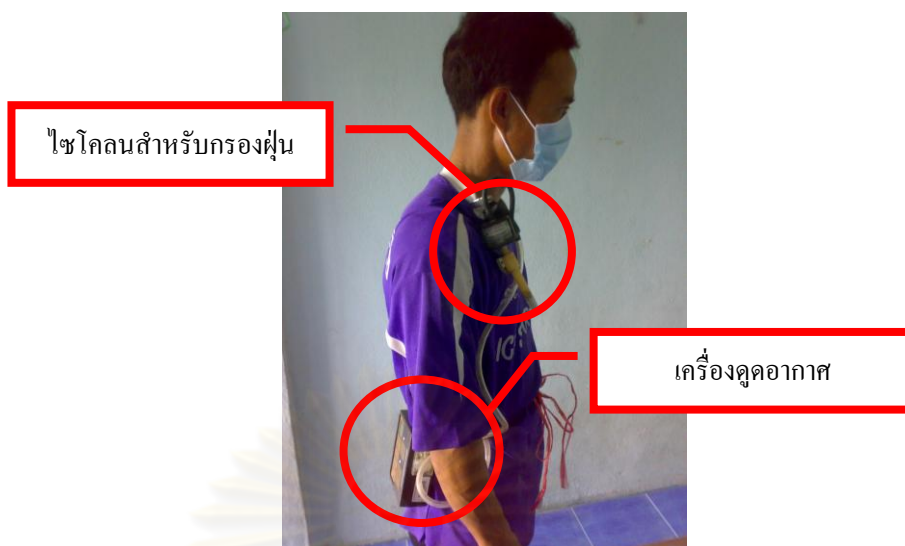
รูปที่ 5.34 การติดตั้งเครื่องเก็บตัวอย่างฝุ่นละอองไว้กับคนงาน
