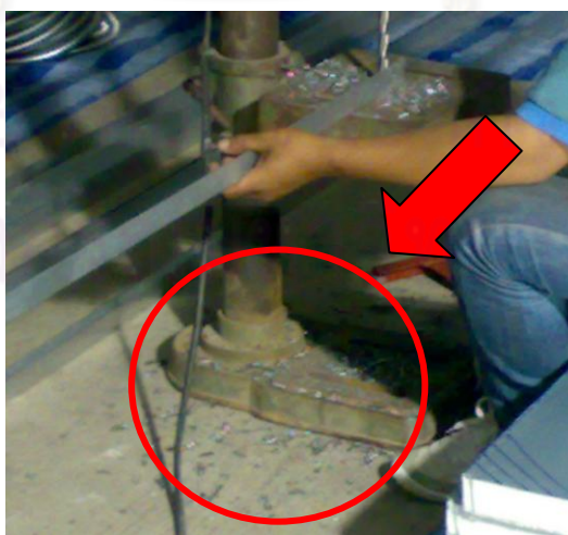
รูปที่ 5.23 เศษวัสดุที่เกิดจากการเจาะโครงอะลูมิเนียม
