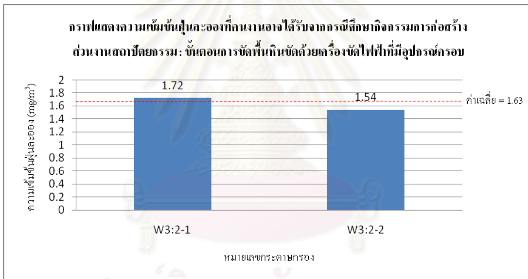
รูปที่ 5.59 กราฟความเข้มข้นฝุ่นละอองจากกรณีศึกษางานขัดพื้นหินขัด การทดลองรูปแบบที่ 2: ขั้นตอนการขัดพื้นหินขัดด้วยเครื่องขัดไฟฟ้าที่มีอุปกรณ์ครอบ
