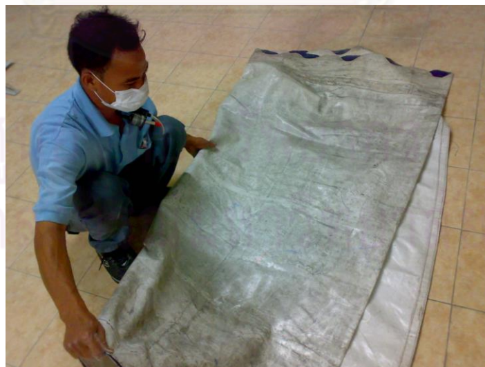
รูปที่ 5.27 การปูแผ่นผ้าบริเวณที่ทำการตัดแผ่นผ้า
