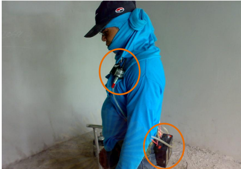
รูปที่ 3.3 การติดตั้งเครื่องเก็บตัวอย่างอากาศส่วนบุคคล พร้อมชุดอุปกรณ์ไซโคลนเข้ากับ คนงานก่อสร้าง
