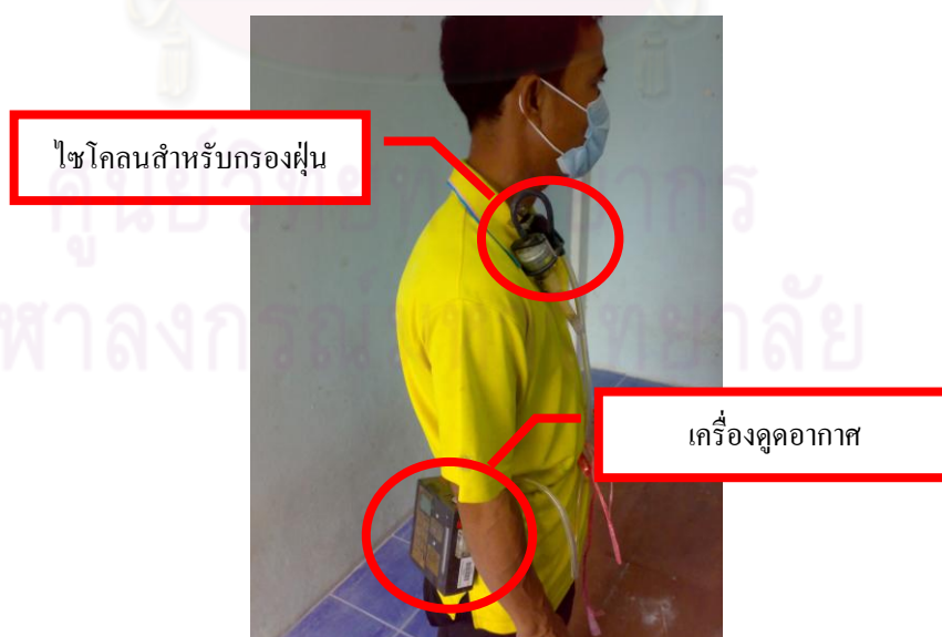
รูปที่ 5.40 การติดตั้งเครื่องเก็บตัวอย่างฝุ่นละอองไว้กับคนงาน
