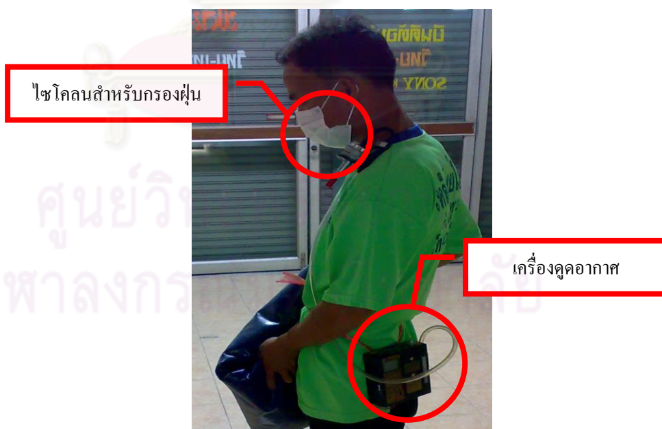
รูปที่ 5.15 การติดตั้งเครื่องเก็บตัวอย่างฝุ่นละอองไว้กับคนงาน
