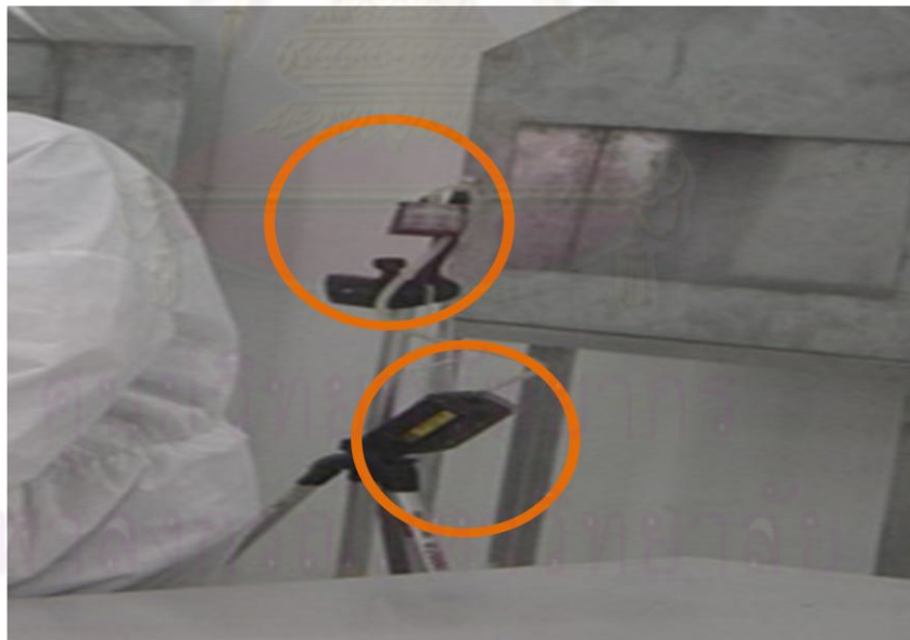
รูปที่ 3.4 การติดตั้งเครื่องเก็บตัวอย่างอากาศส่วนบุคคล พร้อมชุดอุปกรณ์ไซโคลนบนขา ตั้ง
