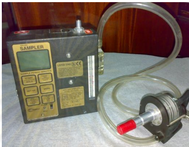
รูปที่ 3.2 เครื่องเก็บตัวอย่างอากาศส่วนบุคคลพร้อมชุดอุปกรณ์ไซโคลน
