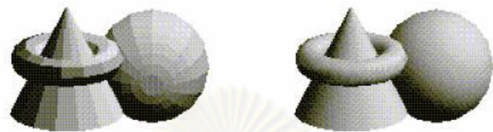
ภาพที่ 3.10 การเรนเดอร์โดยใช้ Normal Vector ของรูปเหลี่ยมและใช้ Normal Vector จริง
