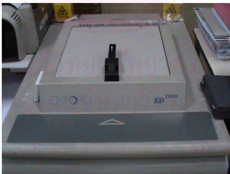
รูปที่ 3.11 เครื่องเอกซเรย์ฟลูออเรสเซนซ์ (XRF)
