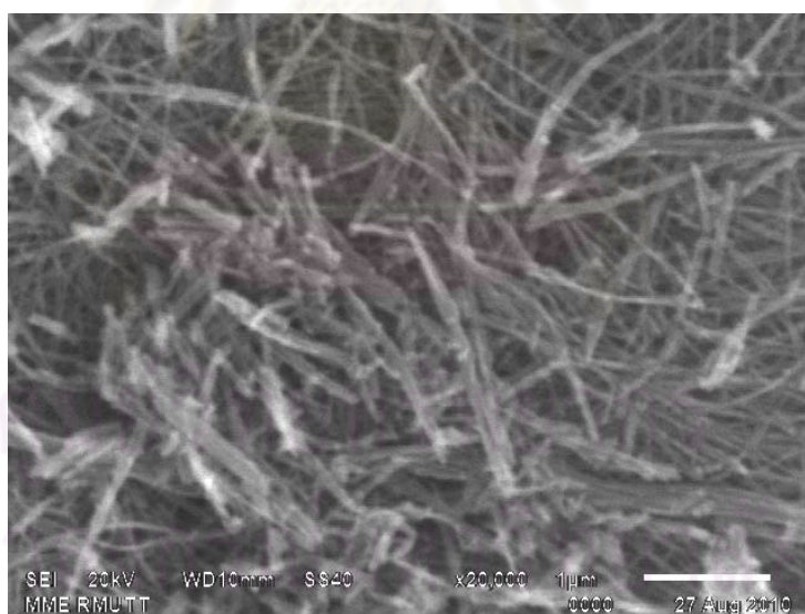
รูปที่ 4.10 ภาพถ่าย SEM ของท่อนาโนไททานเนตจากแร่ลูโคซีน หลังการสังเคราะห์ที่ 105 องศาเซลเซียส เป็นเวลา 24 ชั่วโมง แล้วนำไปเผาที่อุณหภูมิ 550 องศาเซลเซียส เป็นเวลา 2 ชั่วโมง
