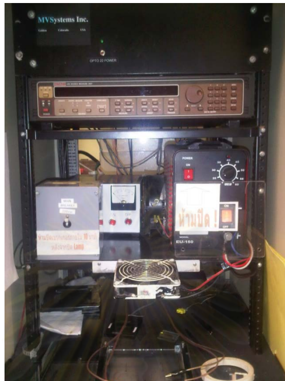
รูปที่ 3.12 เครื่องทดสอบประสิทธิภาพเซลล์พลังงานแสงอาทิตย์
