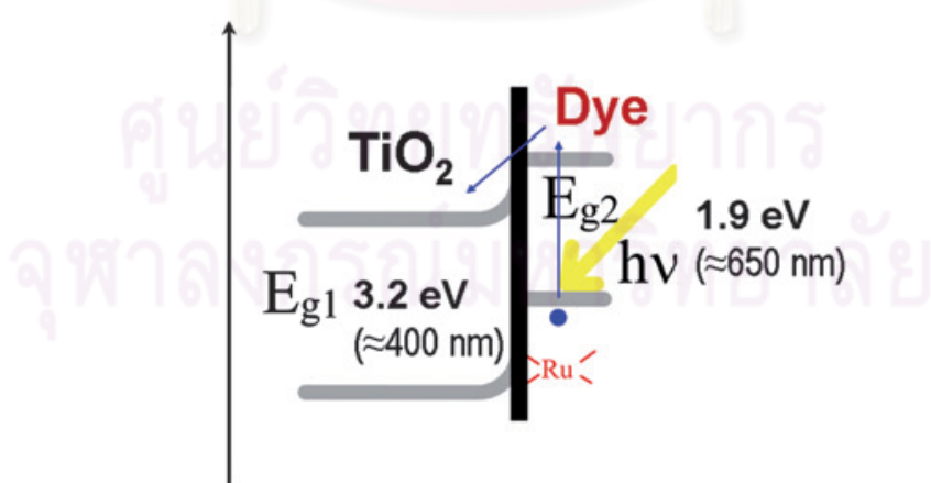
รูปที่ 2.5 แผนภาพแสดงการกระตุ้นอิเล็กตรอนอิสระบนสีย้อมไวแสงหลังการรับแสง[4]
