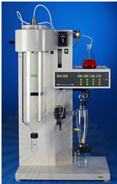
รูปที่ 3.5 เครื่องอบแห้งแบบพ่นฝอย รุ่น B-290
