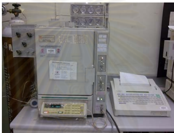
รูปที่ 3.4 เครื่องแก๊สโครมาโตกราฟี รุ่น GC-14B
