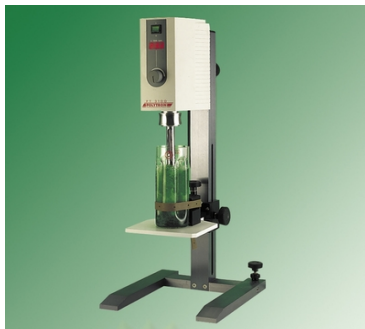
รูปที่ 3.6 เครื่องโฮโมจีไนน์เซอร์ รุ่น Polytron PT 3100
