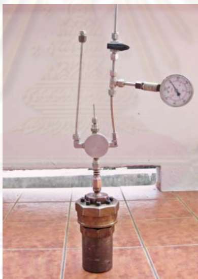
รูปที่ 3.1 เครื่องปฏิกรณ์ขนาดเล็ก ปริมาตร 250 มิลลิลิตร (Micro-reactor)
