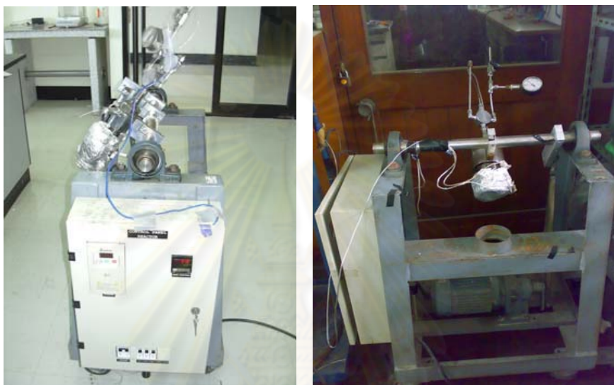
รูปที่ 3.2 ชุดทดลองประกอบด้วยชุดอุปกรณ์ควบคุมอุณหภูมิแบบดิจิตอลและเครื่องเขย่า
