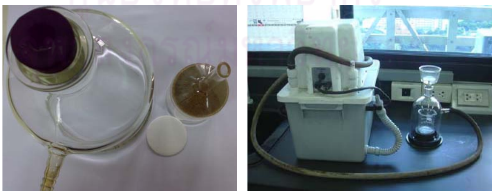
รูปที่ 3.3 ชุดกรองสุญญากาศและกระดาษกรองใยแก้ว
