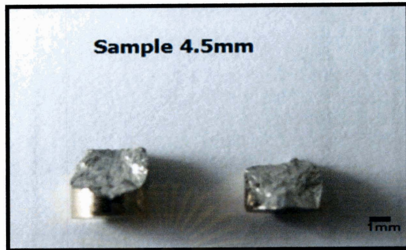
รูปที่4.34 ชิ้นงานเส้นผ่านทรงกระบอก 4.5มิลลิเมตร พังทลายหลังผ่านทดสอบแบบกด
