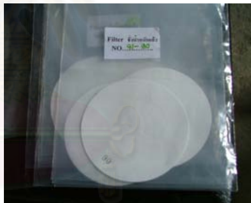
ภาพที่ 3.3 กระดาษกรองที่ใช้เก็บตัวอย่างฝุ่น TSP
