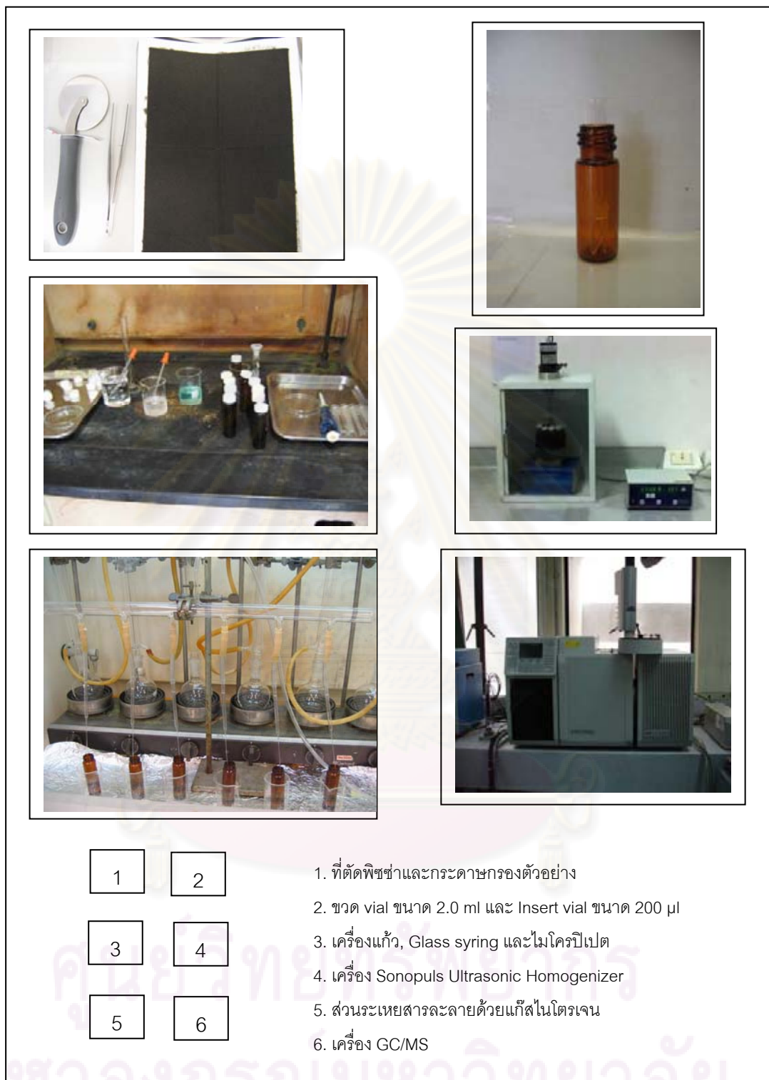
ภาพที่ 3.9 วัสดุอุปกรณ์และเครื่องมือที่ใช้ในการวิเคราะห์หาสารประกอบฟีนอล
