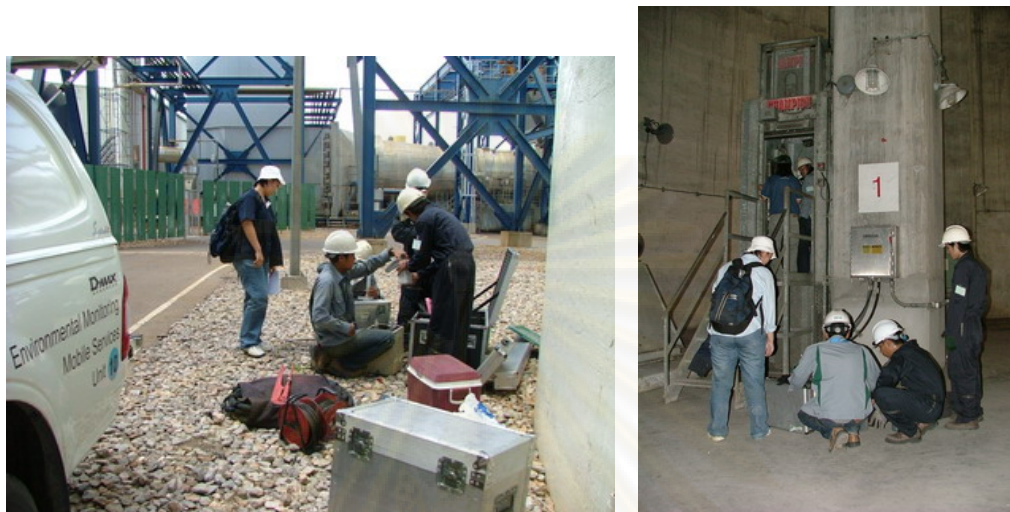
ภาพที่ 3.1 การเก็บตัวอย่างอากาศจากปล่องของโรงไฟฟ้า
