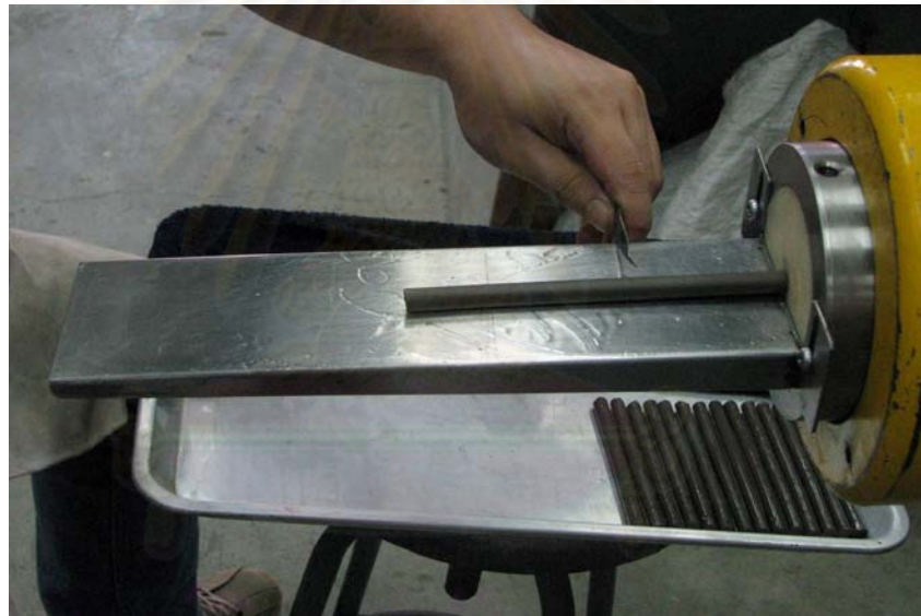
รูปที่ 3.5 การขึ้นรูปแท่งดินทดสอบ
