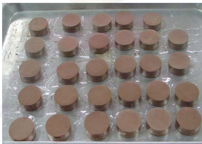
รูปที่ 3.4 แผ่นชิ้นงานกลมขนาด 35 มิลลิเมตร ผึ่งไว้ที่อุณหภูมิห้อง
