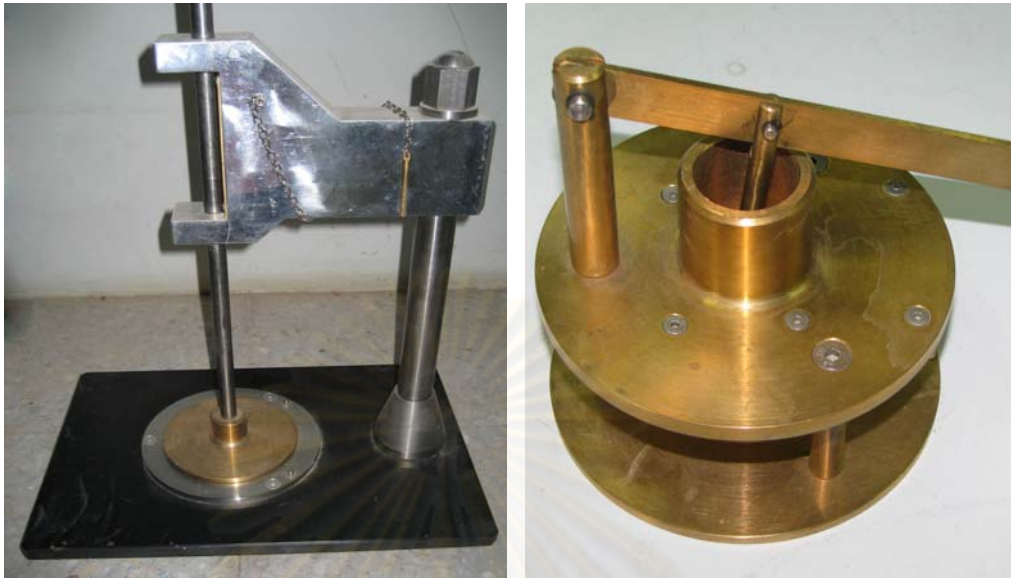
รูปที่ 2.10 เครื่อง Pfefferkorn plastic test และ อุปกรณ์สำหรับเตรียมชิ้นงานทดสอบ
