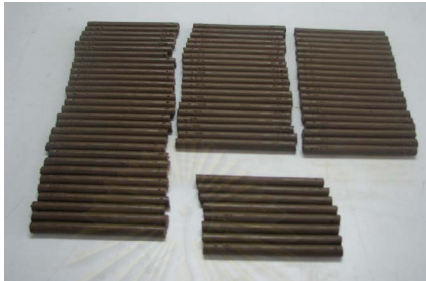
รูปที่ 3.6 รูปแบ่งดินหลังจากรีดนำมาฝังไว้ในห้องทดลอง
