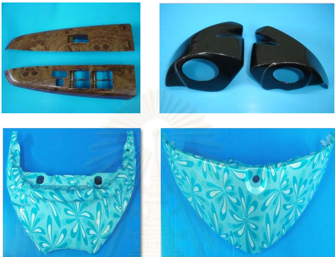
รูปที่ 2.8 ตัวอย่างของชิ้นงานที่ผ่านกระบวนการ Dipping
