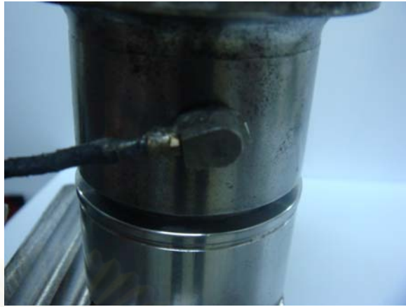
รูปที่ ๑-6 แสดงตำแหน่งของ Accelerometer ที่ติดกับเพลลาหมุน
