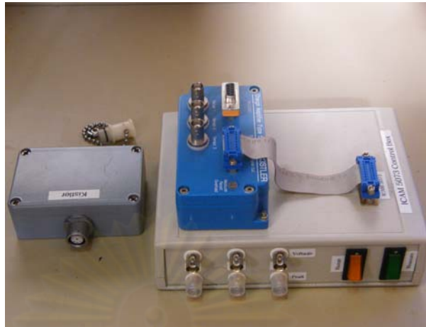
รูปที่ 3.8 ภาพแสดงซาร์จแอมพลิไฟเออร์ที่ใช้ในการทดลอง
