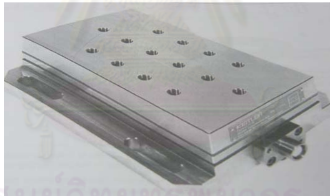
รูปที่ 3.7 : ภาพแสดงเซนเซอร์วัดแรงตัด
