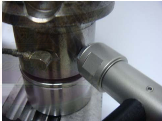
รูปที่ ๑-7 แสดงลักษณะการเคาะบนเพลลาหมุน
