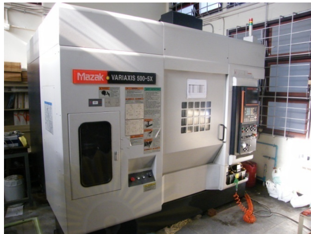
รูปที่ 3.6 : ภาพแสดงเครื่องซีเอ็นซีแมชีนนิ่งเซนเตอร์ 5 แกน
