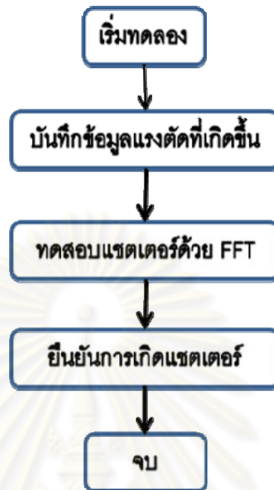
รูปที่ 4.3 แสดงแผนภาพขั้นตอนในการยืนยันการเกิดแชนเตอร์ด้วยโดเมนความถี่
