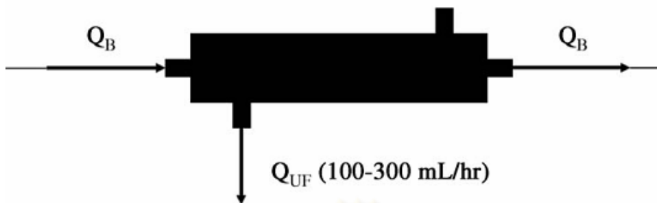
รูปที่ 2 แสดงหลักการของ slow continuous ultrafiltration (SCUF). Q_B , blood flow rate; Q_{uf} , ultrafiltration rate.
