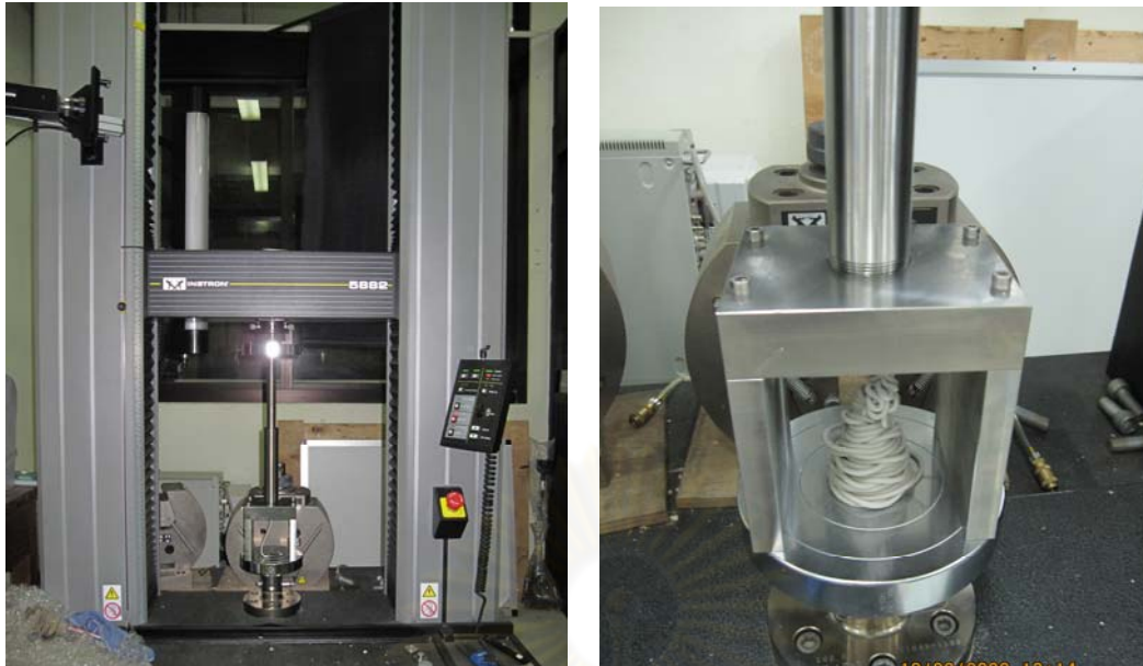
รูปที่ 3.9 Instron Compressing Machine 5882 ณ ศูนย์เครื่องมือคณะวิทยาศาสตร์ จุฬาลงกรณ์มหาวิทยาลัย
