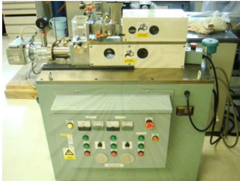
รูปที่ 3.7 เครื่อง Vacuum Extrusion Forming Machine (FM-30-1) ณ ห้องปฏิบัติการเซรามิกส์ ประยุกต์ ศูนย์เทคโนโลยีโลหะและวัสดุแห่งชาติ (MTEC)
