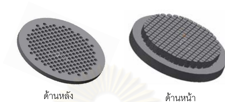
รูปที่ 2.8 ลักษณะของ Die (จากโครงการพัฒนาเซรามิกส์คะตะลิสต์เพื่อพัฒนาเชื้อเพลิงชนิดต่างๆ สำหรับเซลล์เชื้อเพลิง SOFC ของ MTEC)
