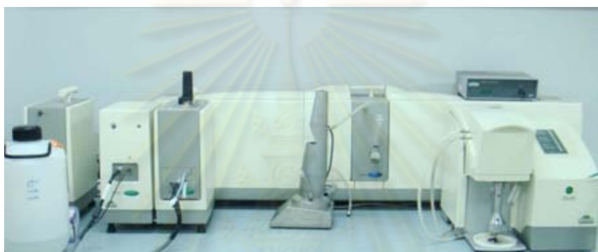
รูปที่ 3.11 เครื่อง Particle Size Analyzer รุ่น Hydro 2000 ผลิตโดยบริษัท Malvern ณ ห้องปฏิบัติการ ภาควิชาวัสดุศาสตร์ คณะวิทยาศาสตร์ จุฬาลงกรณ์มหาวิทยาลัย
