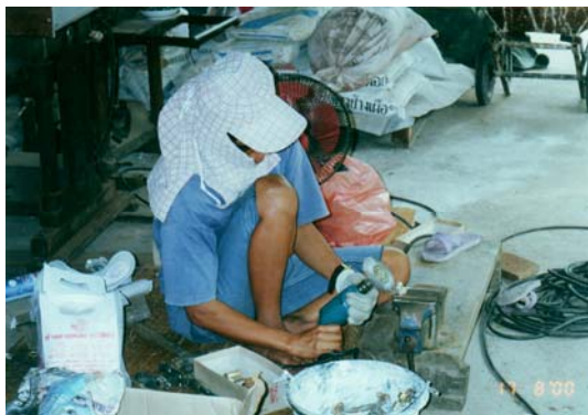
ภาพที่ 4-45 การขัดแต่งผิวอุปกรณ์ประตู หน้าต่าง ทองเหลือง : 2543
