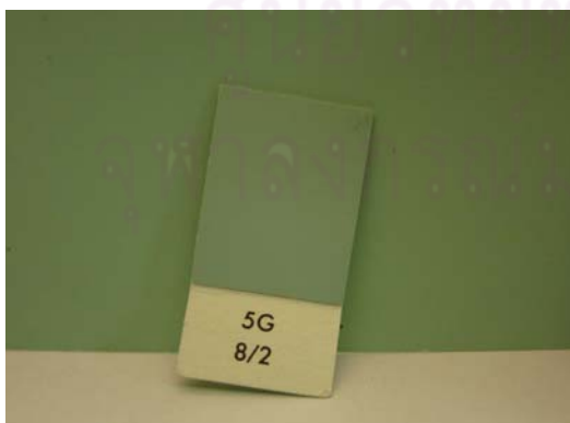
ภาพที่ 4-6 ตัวอย่างสีมันเซลล์เทียบเคียงกับแผ่นสีตัวอย่างยี่ห้อเซอร์วิน วิลเลียม ที่มา : ผู้วิจัย
