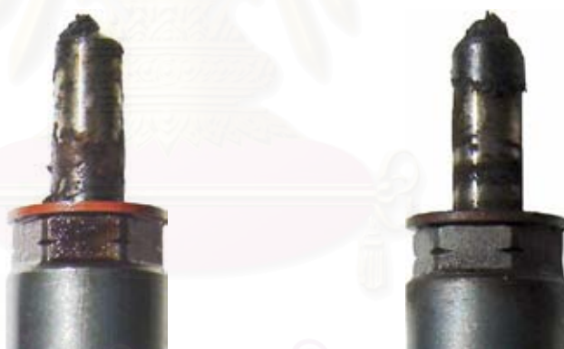
รูปที่ 4-55 แสดงหัวฉีดของเครื่องยนต์ที่ชั่วโมงการทำงานที่ 30 ของการทดสอบความทนทาน (ภาพซ้าย) แสดงหัวฉีดของเครื่องยนต์ที่ทดสอบความทนทานด้วยน้ำมันปาล์มดิบ (ภาพขวา) แสดงหัวฉีดของเครื่องยนต์ที่ทดสอบความทนทานด้วยน้ำมันปาล์มโอเลอิน
