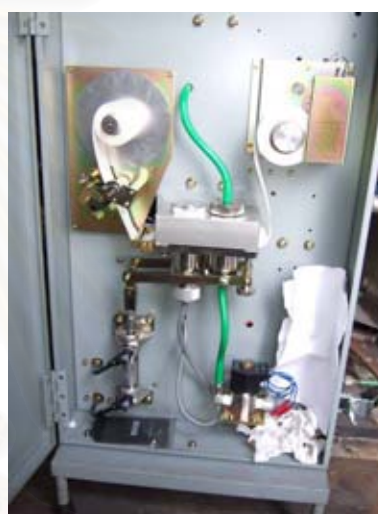
รูปที่ 3-19 แสดงภาพชุดเครื่องมือวัดค่าควันดำ (ภาพซ้าย) ปั๊มดูดไอเสีย รุ่น ETD 020.00 (ภาพขวา) เครื่องอ่านค่าควันดำ ยี่ห้อ Sokken รุ่น GSM – 3DPM
