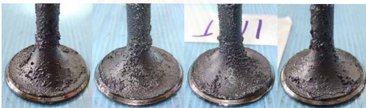
รูปที่ 4-178 แสดงภาพถ่ายวาล์วไฮโดรจากเครื่องยนต์ที่ใช้น้ำมันปาล์มไฮโดร
