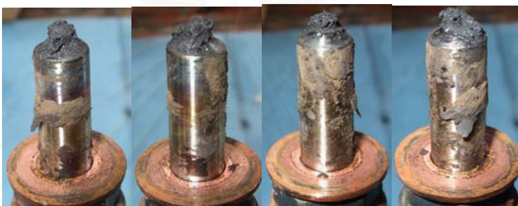
รูปที่ 4-189 แสดงภาพถ่ายหัวฉีดจากเครื่องยนต์ที่ใช้น้ำมันปาล์มโอเลอิน
