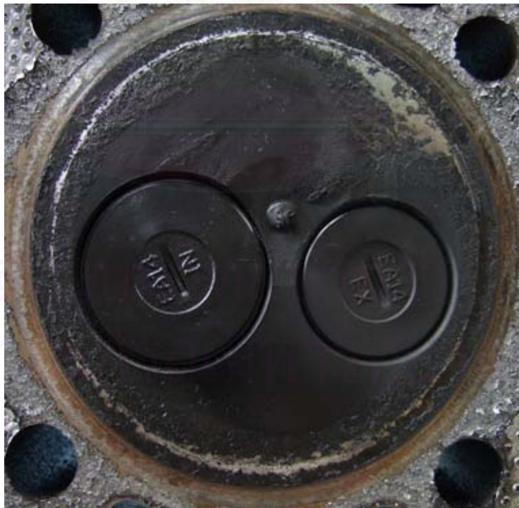
รูปที่ 4-162 แสดงภาพถ่ายฝาสลับหลังจากการทดสอบความทนทาน 320 ชั่วโมง ของเครื่องยนต์ที่ใช้น้ำมันปาล์มโอเลอิน
