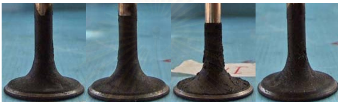
รูปที่ 4-180 แสดงภาพถ่ายวาล์วไอเสียที่ใช้น้ำมันปาล์มดิบ
