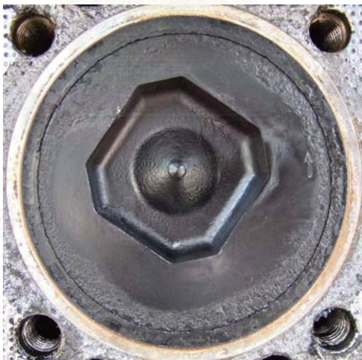
รูปที่ 4-167 ภาพถ่ายลูกสูบจากการทดสอบความทนทานเมื่อใช้น้ำมันปาล์มโอดีเอ็น
