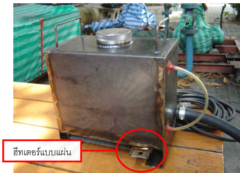
รูปที่ 3-7 แสดงถังสำหรับใช้อุ่นเชื้อเพลิงน้ำมันปาล์มดิบ
