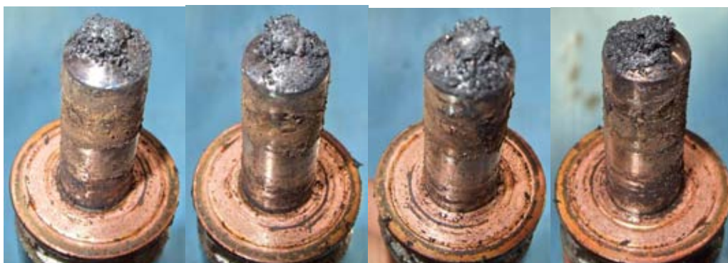
รูปที่ 4-188 แสดงภาพถ่ายหัวฉีดจากเครื่องยนต์ที่ใช้น้ำมันปาล์มดิบ
