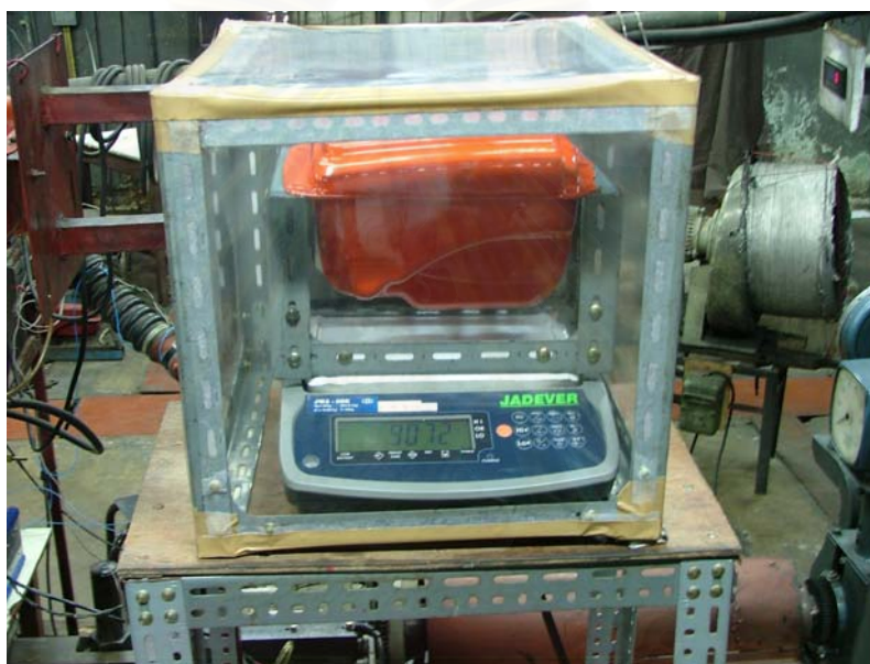
รูปที่ 3-25 แสดงอุปกรณ์การวัดอัตราสิ้นเปลืองน้ำมันเชื้อเพลิง
