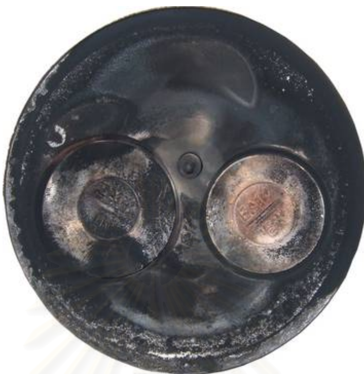
รูปที่ 4-163 แสดงภาพถ่ายฝาสือบหลังผ่านการทดสอบความทนทาน ของเครื่องยนต์ที่ใช้ น้ำมันดีเซล[30]
