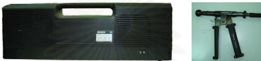
รูปที่ 3-27 แสดงตัวเก็บตัวอย่างควันดำ (ภาพถ่าย) แสดง BOSCH รุ่น RTM430 และ (ภาพขวา) แสดงหัวดูดควันดำของ BOSCH รุ่น RTM430
