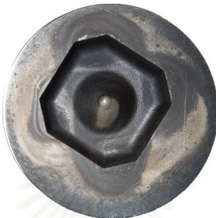
รูปที่ 4-168 ภาพถ่ายแสดงลูกสูบจากการทดสอบความทนทานเมื่อใช้น้ำมันดีเซล
