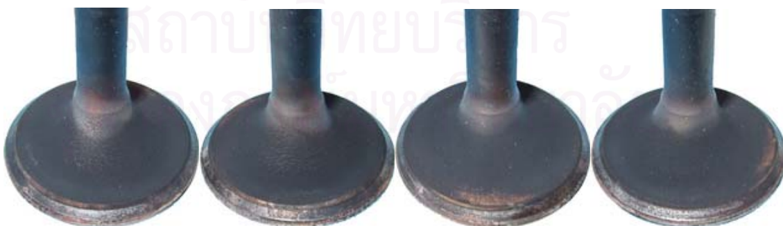
รูปที่ 4-182 แสดงภาพถ่ายวาล์วไอเสียจากที่ใช้น้ำมันดีเซล
