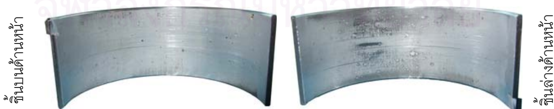
รูปที่ 4-192 แสดงภาพถ่ายแบริงก้านสูบ ภายหลังจากทดสอบความทนทานของเครื่องยนต์ที่ใช้น้ำมันดีเซล (500 ชั่วโมง)
