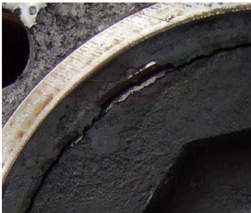
รูปที่ 4-169 ภาพถ่ายขยายส่วนหนึ่งของลูกสูบของเครื่องยนต์ที่ใช้น้ำมันปาล์มดิบ ในบริเวณที่มีรอยแตกของเขม่าที่ลูกสูบ
