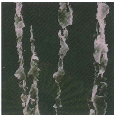
รูปที่ 2-19 แสดงอนุภาคการสึกหรอที่เกิดจากการเสียดสีกันของโลหะกับโลหะ
