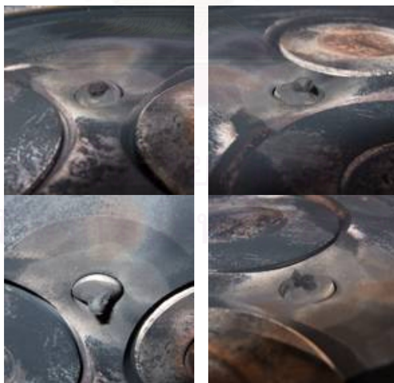
รูปที่ 4-187 แสดงภาพถ่ายหัวฉีดจากเครื่องยนต์ที่ใช้ น้ำมันดีเซล ก่อนถอดออกจากฝาสูบ
