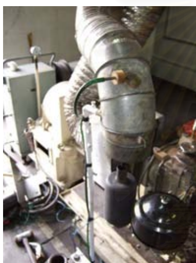
รูปที่ 3-19 แสดงภาพชุดเครื่องมือวัดค่าควันดำ (ภาพซ้าย) ปั๊มดูดไอเสีย รุ่น ETD 020.00 (ภาพขวา) เครื่องอ่านค่าควันดำ ยี่ห้อ Sokken รุ่น GSM – 3DPM
