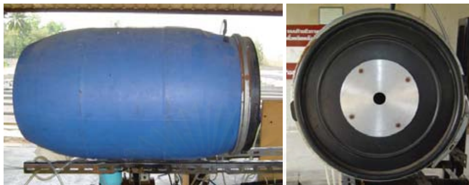
รูปที่ 3-17 แสดงถึงพักอากาศและการติดตั้ง orifice plate
