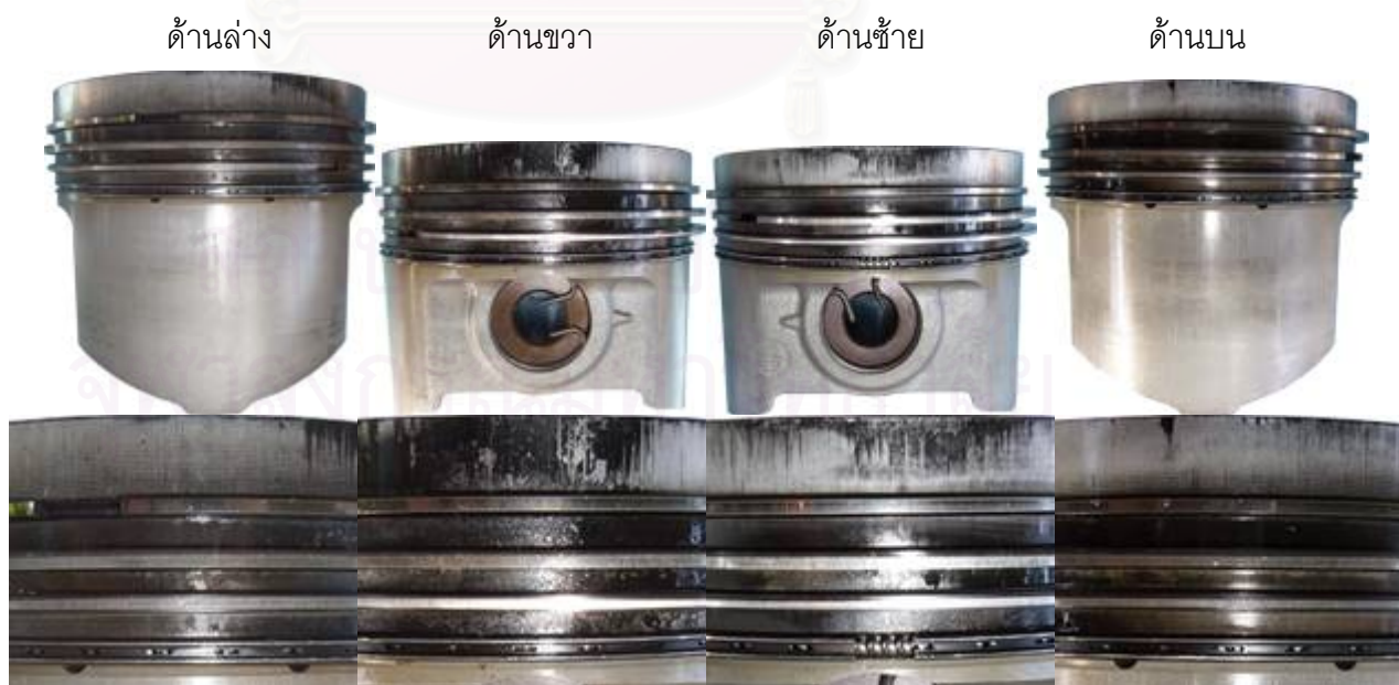
รูปที่ 4-172 ลูกสูบจากการทดสอบความทนทานเมื่อนำน้ำมันดีเซลและภาพขยาย
