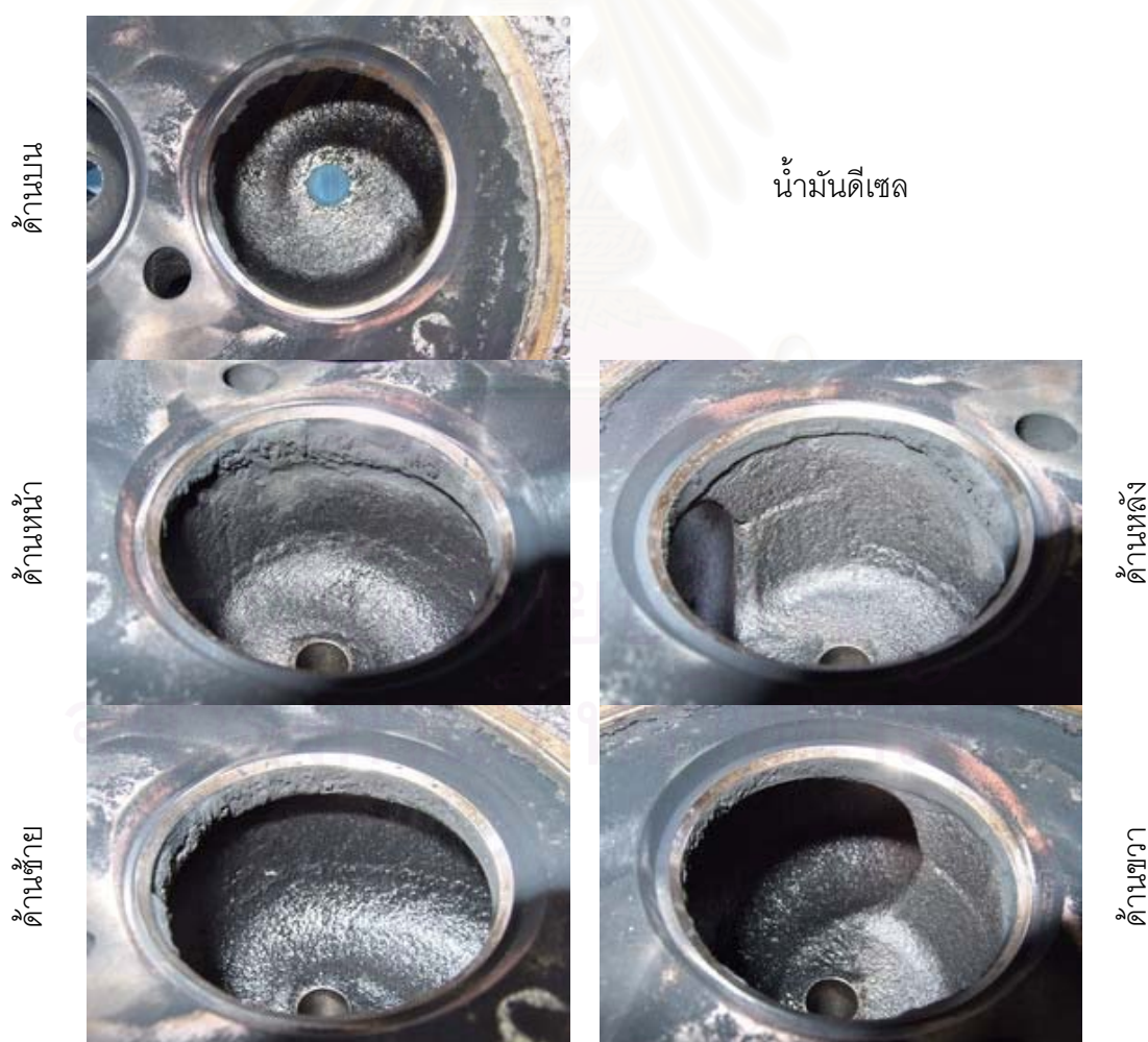
รูปที่ 4-173 แสดงภาพถ่ายบำนวาล์วไอดีของ เครื่องยนต์ที่ใช้ น้ำมันดีเซล
