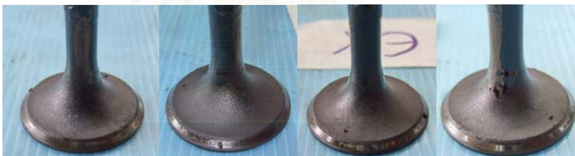
รูปที่ 4-181 แสดงภาพถ่ายวาล์วไอเสียที่ใช้น้ำมันโอเลอิน
