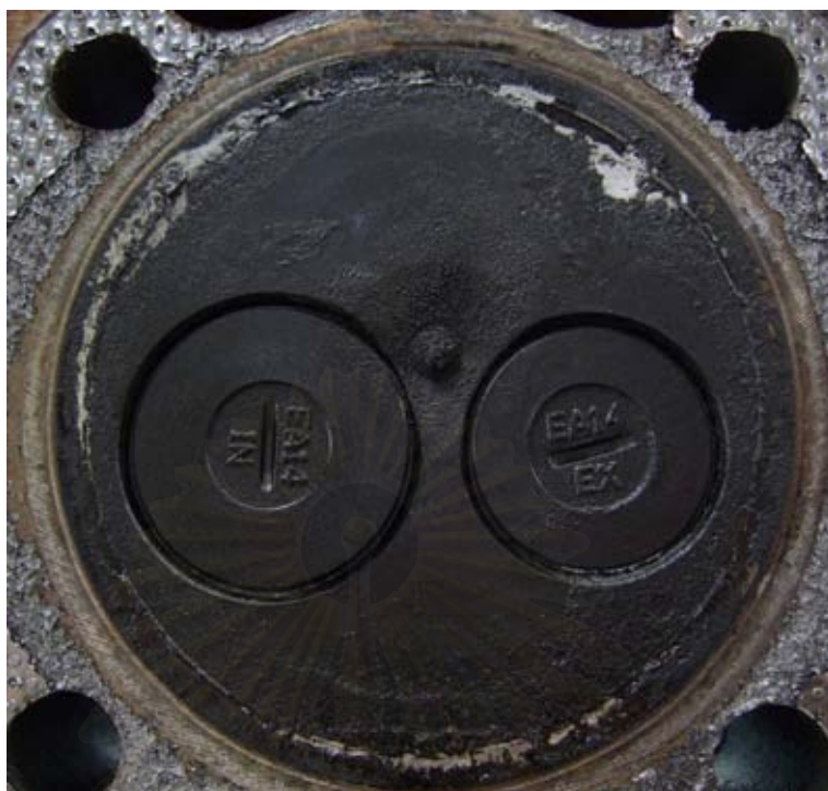
รูปที่ 4-161 แสดงภาพถ่ายฝาสลับหลังจากการทดสอบความทนทาน 320 ชั่วโมง ของเครื่องยนต์ที่ใช้น้ำมันปาล์มดิบ
