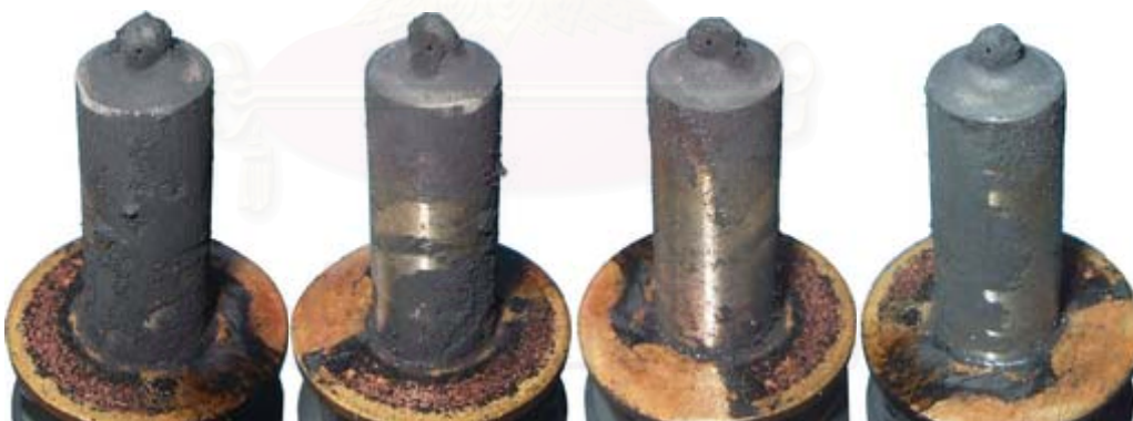
รูปที่ 4-190 แสดงภาพถ่ายหัวฉีดจากเครื่องยนต์ที่ใช้น้ำมันดีเซล
