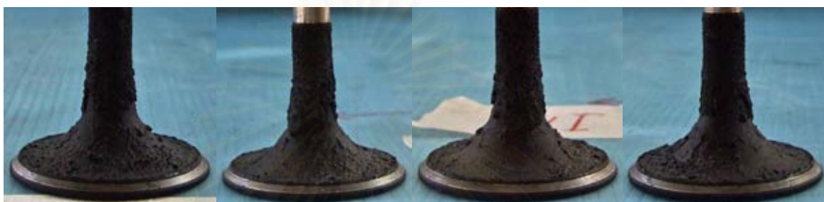
รูปที่ 4-177 แสดงภาพถ่ายวาล์วไฮโดรจากเครื่องยนต์ที่ใช้น้ำมันปาล์มดิบ
