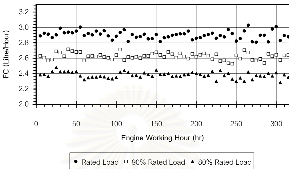
รูปที่ 4-66 แสดงอัตราสิ้นเปลืองน้ำมันเชื้อเพลิง (FC) ตลอดช่วงการทดสอบความทนทานที่สภาวะการทำงานที่ 1, 2 และ 3 ของเครื่องยนต์ที่ใช้ น้ำมันดีเซล [30]
