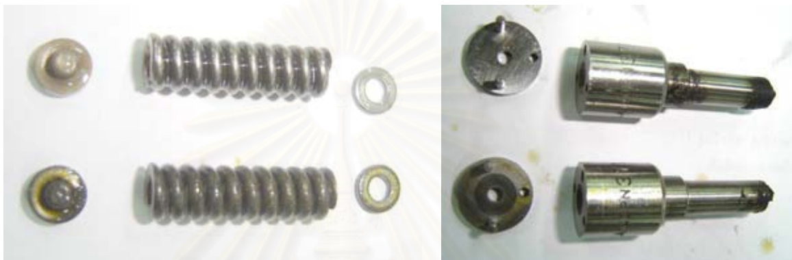
รูปที่ 4-56 แสดงชิ้นส่วนภายในหัวฉีดที่ชั่วโมงที่ 30 ของการทดสอบความทนทาน (ชิ้นส่วนบน) ชิ้นส่วนภายในหัวฉีดของเครื่องยนต์ที่ใช้น้ำมันปาล์มโอเลอิน (ชิ้นส่วนล่าง) ชิ้นส่วนภายในหัวฉีดของเครื่องยนต์ที่ใช้น้ำมันปาล์มดิบ
