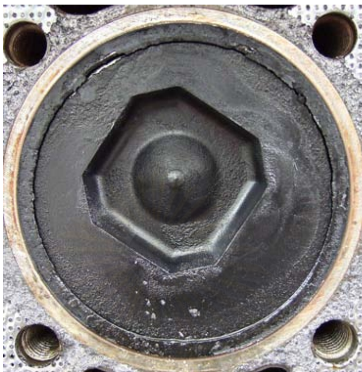
รูปที่ 4-166 ภาพถ่ายลูกสูบจากการทดสอบความทนทานเมื่อใช้น้ำมันปาล์มดิบ
