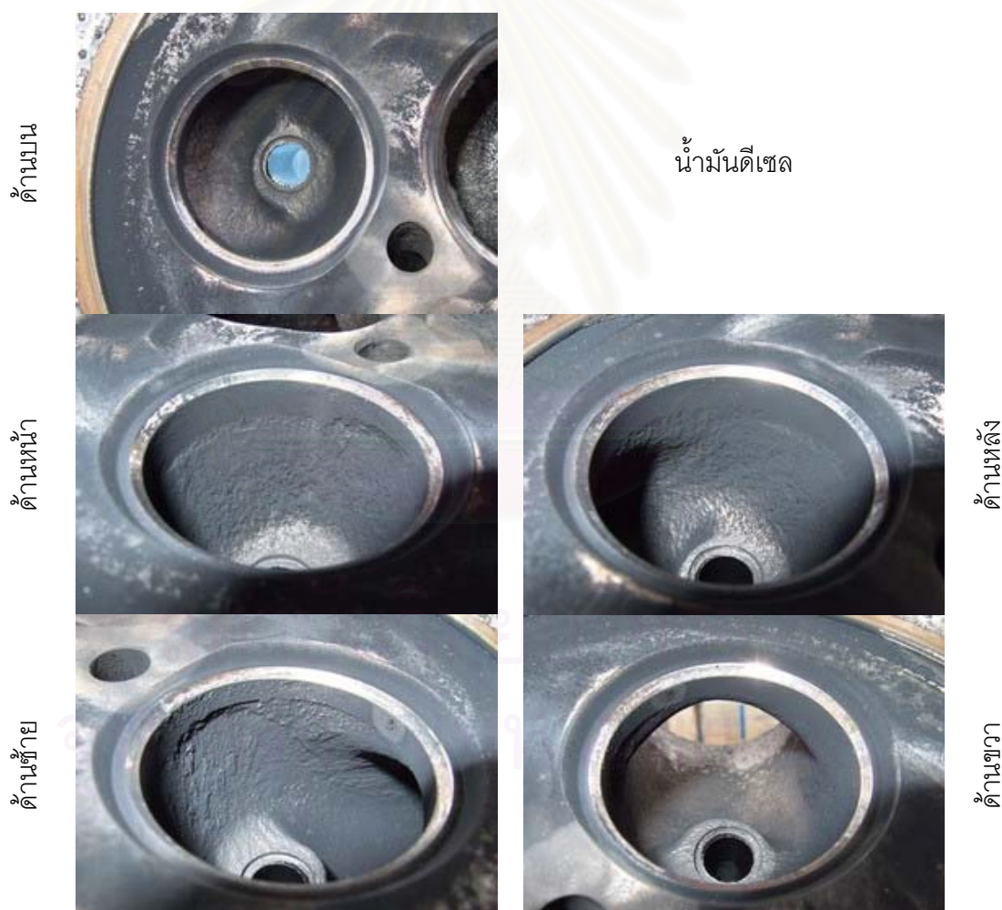
รูปที่ 4-175 แสดงภาพถ่ายบ่าวาล์วไอเสียของ เครื่องยนต์ที่ใช้น้ำมันดีเซล
