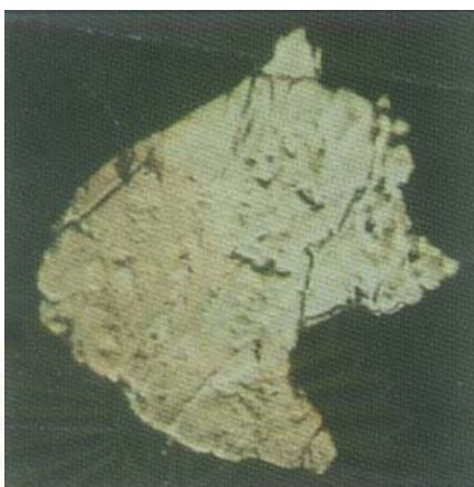
รูปที่ 2-22 แสดงอนุภาคการสึกหรอที่เกิดจากการล้าบนเฟือง (Gear Fatigue Particle)
