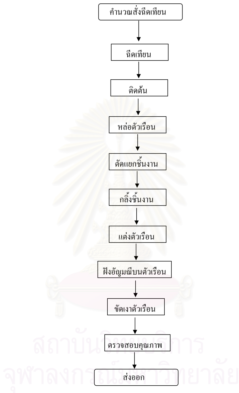
รูปที่ 4.4 กระบวนการในการผลิตเครื่องประดับ
