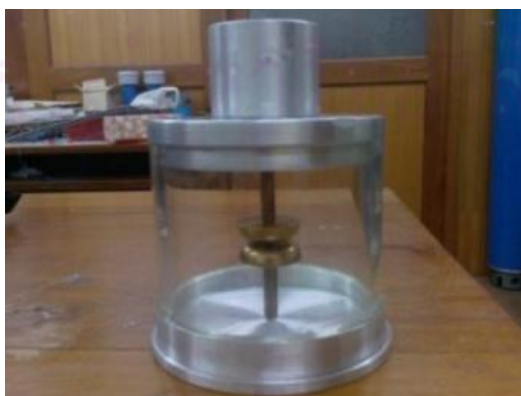
รูปที่ 4.3 การติดตั้งอิเล็กโตรดเข้ากับเซลล์ทดลอง
