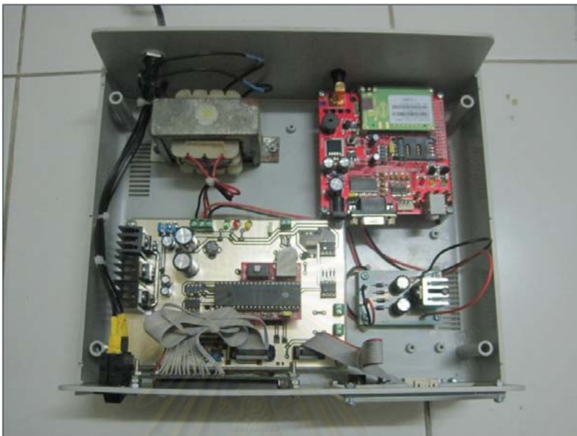
รูปที่ 3.11 ชุดวงจรของระบบเฝ้าติดตามคุณภาพพจนวนของหม้อแปลงไฟฟ้าที่พัฒนาขึ้น
