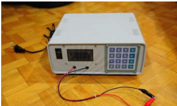
รูปที่ 3.18 ระบบเฝ้าติดตามคุณภาพฉนวนของหม้อแปลงไฟฟ้ากำลังที่ใช้อยู่ในระบบจำหน่ายประกอบแล้วเสร็จ
