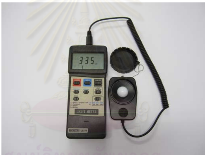
ภาพที่ 3-1 แสดงเครื่องวัดความเข้มแสงแบบดิจิตอล
