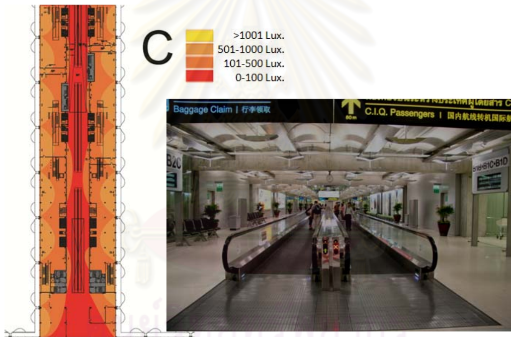
ภาพที่ 4-24 ภาพถ่ายภายในอาคาร และปริมาณความส่องสว่าง (Lux.) ที่วัดได้ภายในอาคารเทียบเครื่องบิน C (CC-C) ณ. เวลา 19.00 - 20.00 น.
