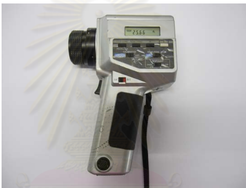
ภาพที่ 3-2 แสดงเครื่องวัดค่าความสว่างของวัสดุ
