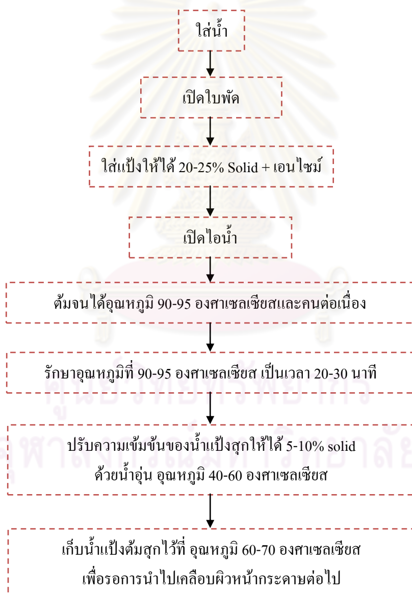
รูปที่ 12 แสดงขั้นตอนการย่อยแป้งแบบกะ [4]
