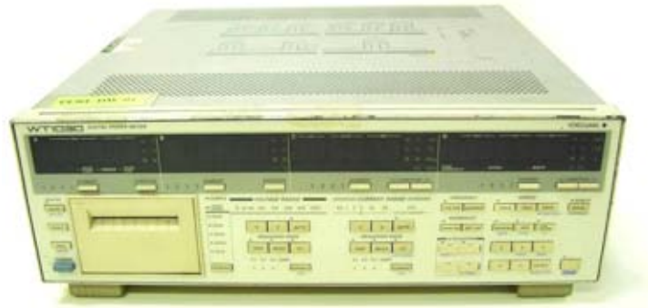
รูปที่ 4-12 เครื่องวัดกำลังไฟฟ้ายี่ห้อ YOKOGAWA รุ่น WT1030
