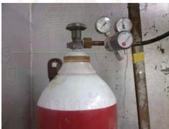
รูปที่ 4-2 ถังบรรจุไฮโดรเจน ความบริสุทธิ์ 99.99% ขนาด 7 ลูกบาศก์เมตร พร้อม pressure regulator
