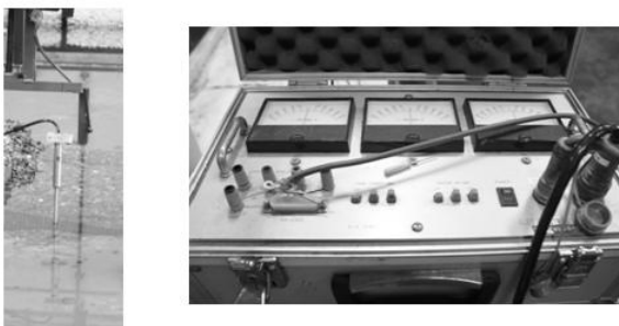
รูปที่ ข-5 เครื่องรับสัญญาณและจอแสดงผลของเครื่องมือวัดความเร็วคลื่น แบบ ACM-300 ของบริษัท ALEC ELECTRONIC
