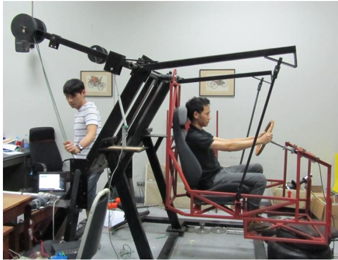
ภาพที่ 34 ตำแหน่งการติดตั้งอุปกรณ์ต่างๆ บนโครงสร้างของระบบจำลองการขับขี่ยานยนต์
