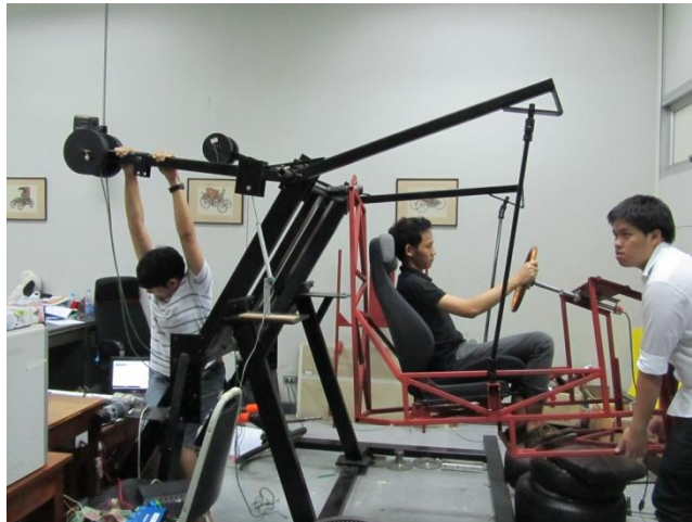
ภาพที่ 40 ยกโครงสร้างให้เอียงที่มุมการโคลง 10 องศาซึ่งเป็นมุมเริ่มต้น
