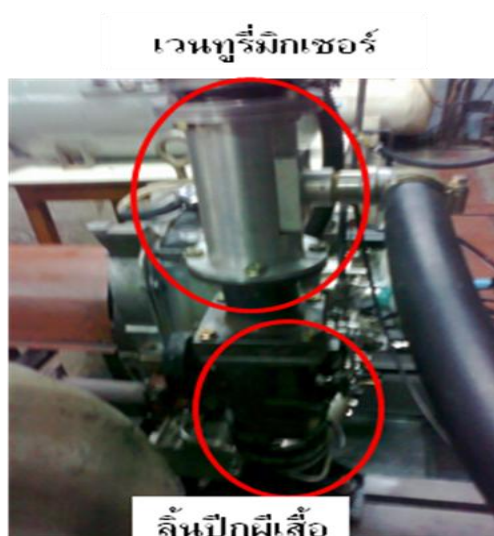
ภาพที่ 5-21 การติดตั้งเวนทูรีมิกเซอร์เข้ากับลิ้นปีกผีเสื้อก่อนเข้าเครื่องยนต์
