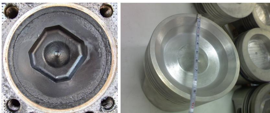
ภาพที่ 5-18 ลักษณะรูปทรงของลูกสูบที่ได้ทำการดัดแปลง [28]
