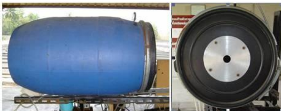
ภาพที่ 5-10 ถังพักอากาศและการติดตั้ง Orifice Plate
