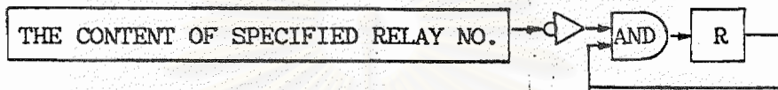
รูปที่ 4.23 แสดงการใช้งาน และการทำงานของคำสั่ง AND NOT
