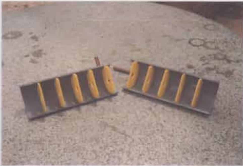
รูปที่ 3.28 ภาพถ่ายเครื่องแลกเปลี่ยนความร้อน
